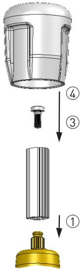
1. Langspindel auf Sternaufnahme des Ventils aufstecken.
