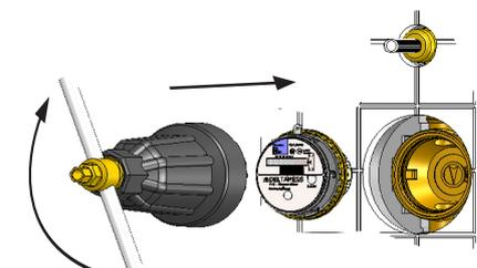
8. Wasserzulauf öffnen und Zähler auf Dichtheit und Fließrichtung prüfen!
