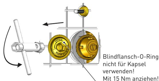
7. Schutzkappe (schwarz) von der Messkapsel entfernen. Werksseitig eingefettete Trockenkapsel (Messeinsatz) ggf. nachfetten und in das Miniblockgehäuse einsetzen.
