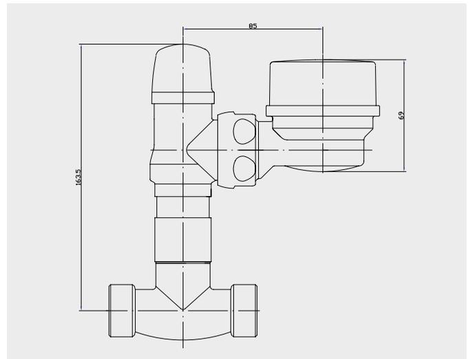
Der konformitätsbewertete Wasserzähler ist nach der vorgeschriebenen Frist problemlos auswechselbar. Dieser Austauschzähler passt als Bauteil auch auf vorhandene Allmess-Ventilmesszähler CONTROLLER-V ab Baujahr 1984.
