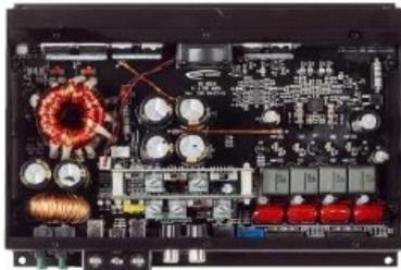
Die verstärkenden Halbleiter sitzen typisch unter der Platine, von oben ist rechts unten nur die Ausgangsfilterung mit Spulen und Kondensatoren zu sehen
