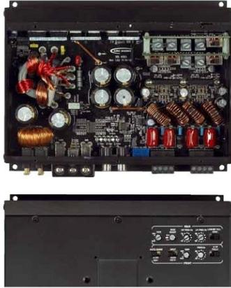
In der winzigen Arc geht es aufgeräumt zu. Die Leistungschips sitzen unter der Platine, der Alu-Kühlkörper ist untenrum gezogen
