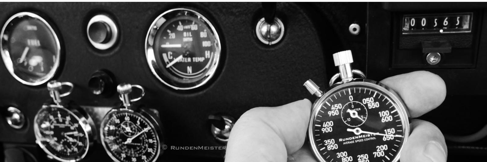
Gibt die Soll- Wegstrecke einer typischen Rallye-Aufgabe (Stundenmittel, km/h) vor. Der Abgleich erfolgt mit dem Wegstreckenzähler. Angezeigt wird die Strecke in Metern (großer Zeiger) und Kilometern (kleiner Zeiger), wie im Bild gezeigt (5,650 km). Zwei Umläufe entsprechen 1000 Metern. Mit Flyback – Funktion.
