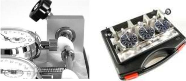
Kugelgelagerte Welle mit Nocken aus Polyacetal.
