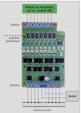
sections de voie surveillées) sont séparées galvaniquement des sorties (pour le raccordement des modules de rétroaction numériques). Les signaux (c'est-à-dire les messages d'occupation) sont certes transmis, mais pas l'énergie électrique.
