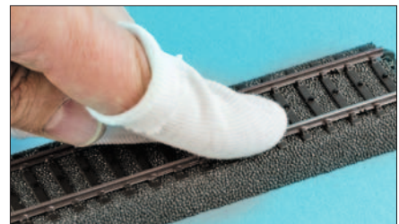
Im ersten Durchgang werden nur die Bereiche zwischen den Schwellen – die sog. Schwellenfächer – mit Weißleim bestrichen. Zeitnah erfolgt dann ...
