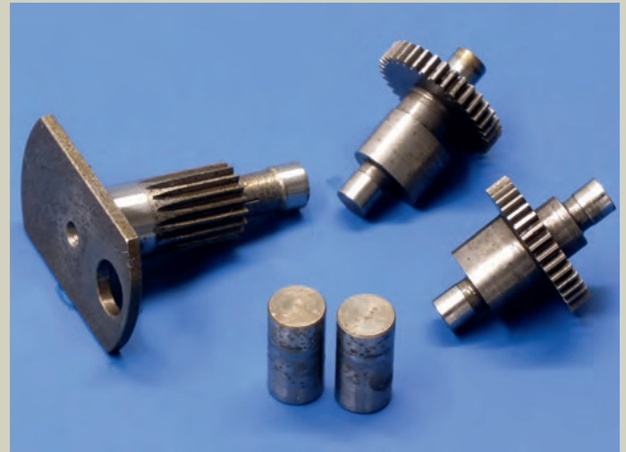
Die Nockenwellen mit Stößeln und Antrieb (rechts)
