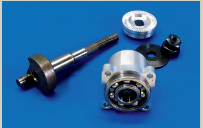
Das Kurbelwellen-Lagergehäuse ist aus dem Vollen gefertigt.
