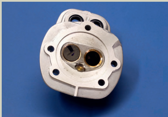
Der Blick in den Brennraum – das Auslassventil ist ausgebaut.
