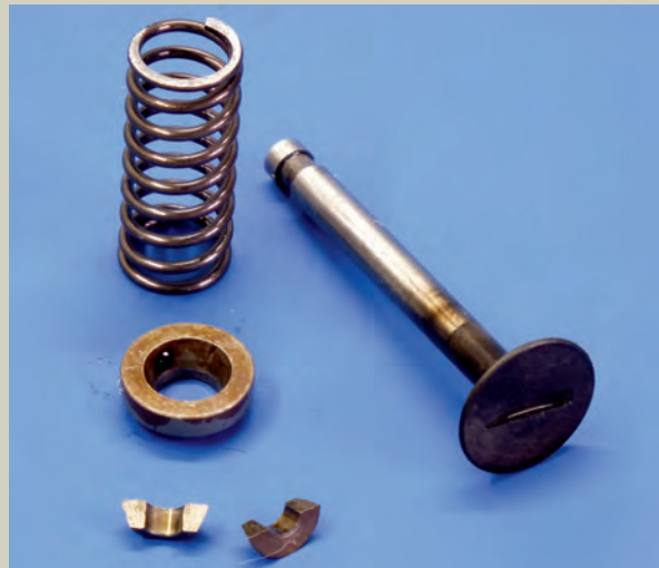
Das Auslassventil mit Feder, Federteller und Kegelhälften.
