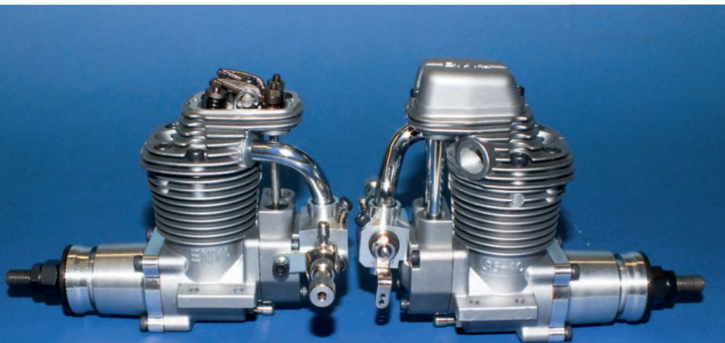
Die Versionen C und CD unterscheiden sich lediglich im Lieferumfang: der Diesel wird mit offenen Stößelstangen geliefert, da die Hüllrohre erst nach den ersten Läufen montiert werden können.
