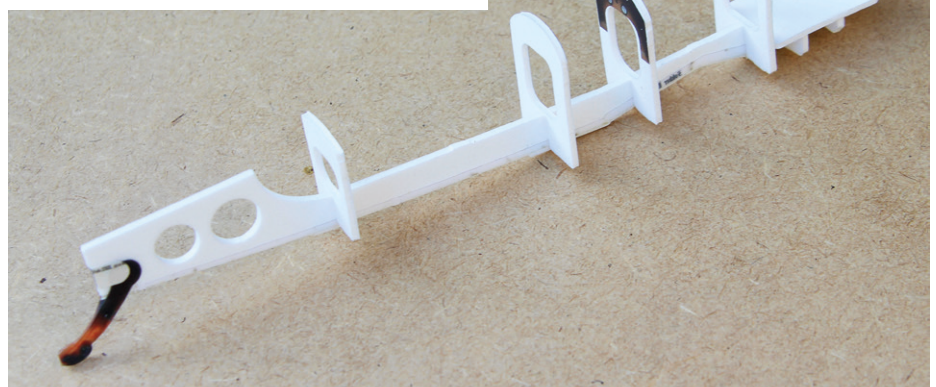
An die chirurgischen Arbeiten im Plastikmodellbaumaßstab 1:24 muss man sich gewöhnen. Hier sieht man die Rumpfspanten auf dem Längsträger.
