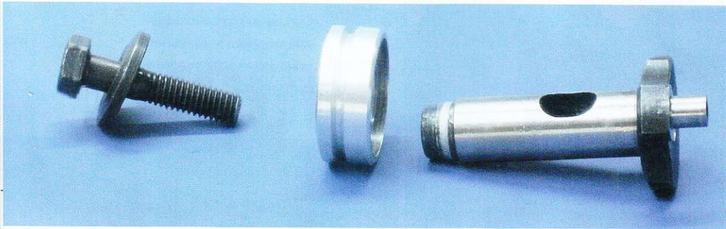
Die Kurbelwelle mit der Propellernabe und -schraube.
