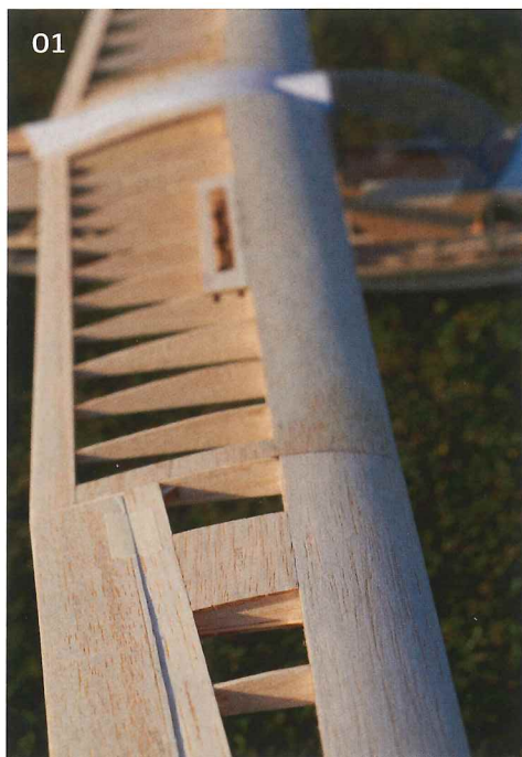
01 | Die Tragfläche in klassischer Rippenbauweise. Jedes Bepunktungsstück war passend gelasert 02 | Selbst die Leitwerke sind vorbildgetreu. Das Höhenleitwerk ist abnehmbar
