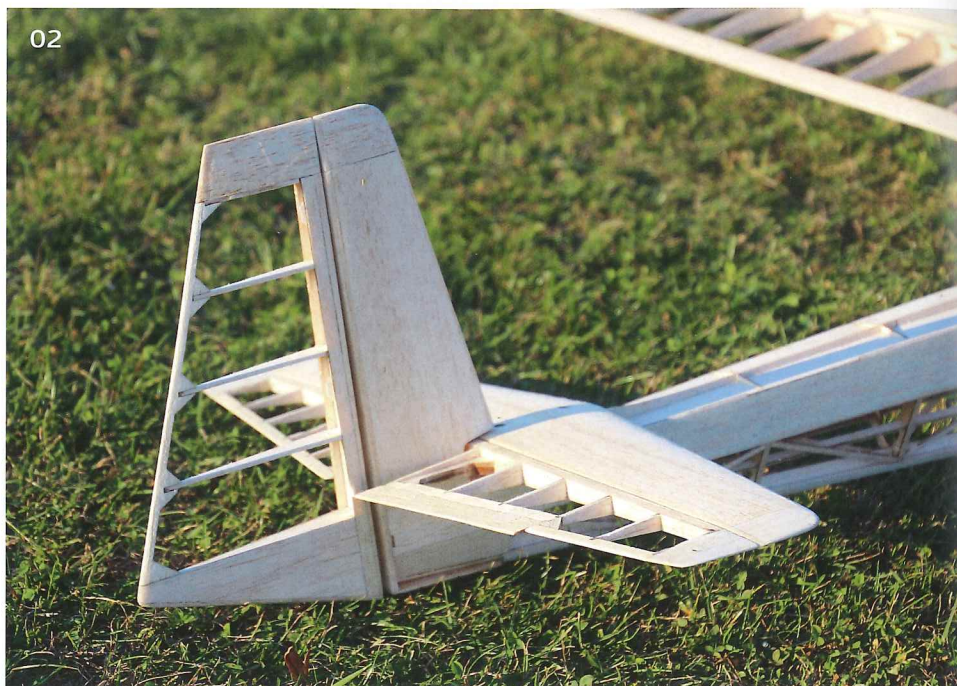
01 | Die Tragfläche in klassischer Rippenbauweise. Jedes Bepunktungsstück war passend gelasert 02 | Selbst die Leitwerke sind vorbildgetreu. Das Höhenleitwerk ist abnehmbar
