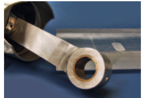
Die Pleuelaugen sind ausgebüchst und mit drei Ölbohrungen versehen.
