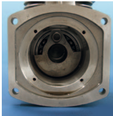
Blick ins Kurbelgehäuse – der Motor-träger ist als Rückwandflansch bereits in der Gehäuseform integriert.
