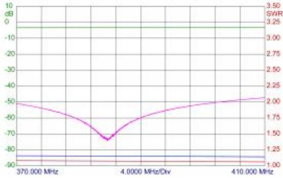
TYPISCHER KURVENVERLAUF ANTENNEN MU 1-Z/S (MIT 1.5 M KABEL)
