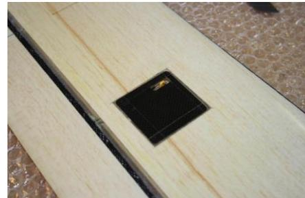
Um das **Anschlusskabel in der Wurzelrippe** verschwinden zu lassen, fräst man einen entsprechenden **Schlitz ins Balsa**.
