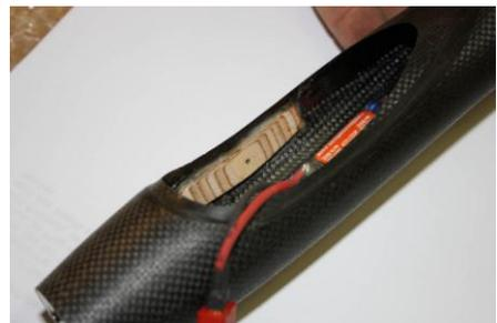
Unter der Kabinenhaube sind **Motor und Regler** untergebracht.
