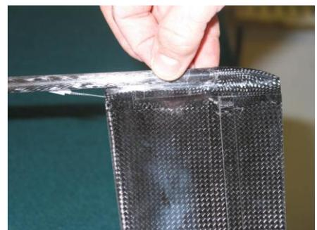
Dann legt man das Modell verkehrt auf einen ebenen Tisch. Das Leitwerk wird solange um die Rumpfachse gedreht, bis beide Flächenspitzen und beide Leitwerksspitzen am Tisch aufliegen.
