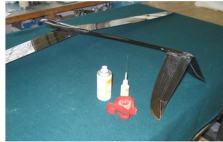
Die **EWD** (Winkel zwischen Tragfläche und Höhenleitwerk) soll **1,8°** betragen. Die Teile sind so vorgefertigt, dass sich der Winkel automatisch ergibt. Trotzdem sollte das genaue Maß überprüft werden. Die Einstellung der EWD kann gemäß nachstehender Zeichnung erfolgen.
