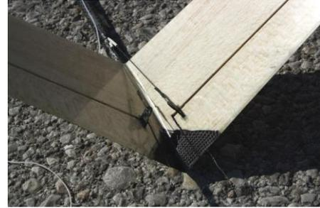
Das Leitwerk wird nun auf das Rohr aufgesetzt und dort verklebt. Vor der Verklebung sollte die **Ausrichtung des Leitwerkes um die Rumpfachse** sowie die **EWD** kontrolliert werden, damit das Leitwerk auch korrekt auf dem Rumpf sitzt.
