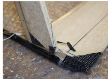
Diese Stelle wird dann mit **Sekundenkleber** gehärtet.
