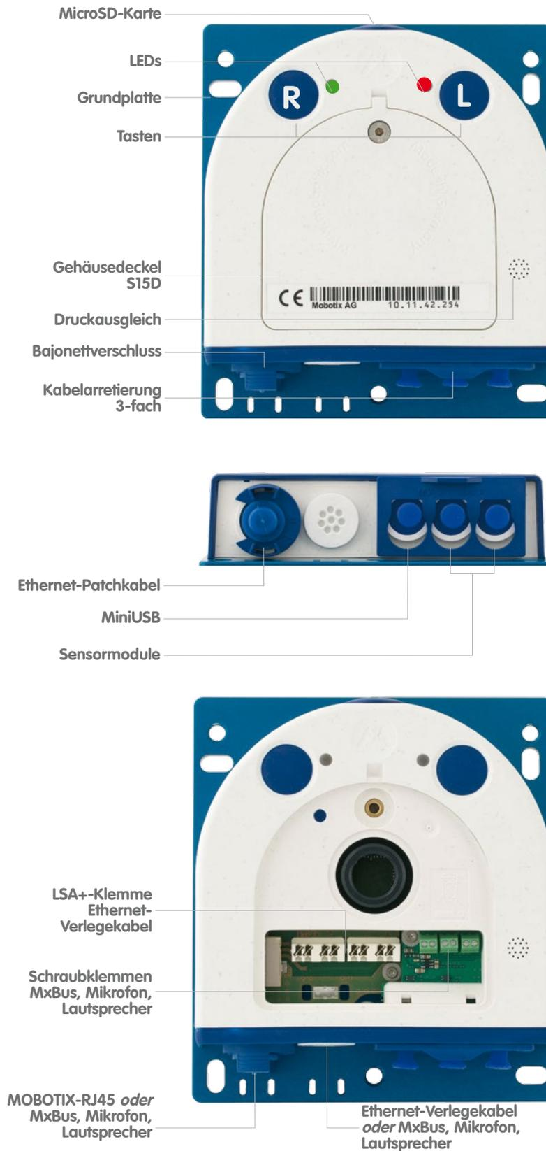
(S15 – Kameragehäuse und Anschlüsse, Auszug aus der technischen Dokumentation)
