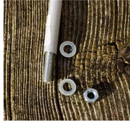
3. Steckt eine Unterlegsscheibe zurück auf die Gewindestange. Steckt dann die Gewindestange durch das Bohrloch im unteren Rahmen (Abbildung links). Steckt auf der anderen Seite die zweite Unterlegsscheibe auf die Stange und schraubt die Mutter fest (Abbildung rechts).
