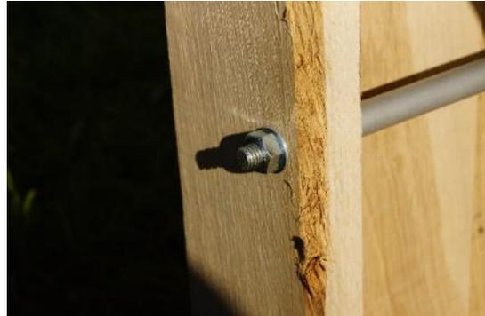
b) Schraubt eine zusätzliche mittlere Schraubenmutter ein, falls das Rohr immer noch zu weit unten endet.
