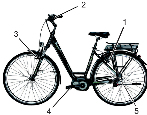
Bremssystem eines Fahrrads mit einer Rücktrittbremse, Beispiel
