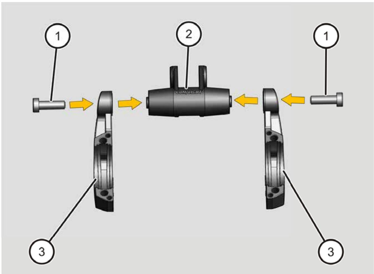
ⓘ Der optionale COM/CAM Adapter kann analog zum COM/LIGHT mit den Klemmarmen befestigt werden.
