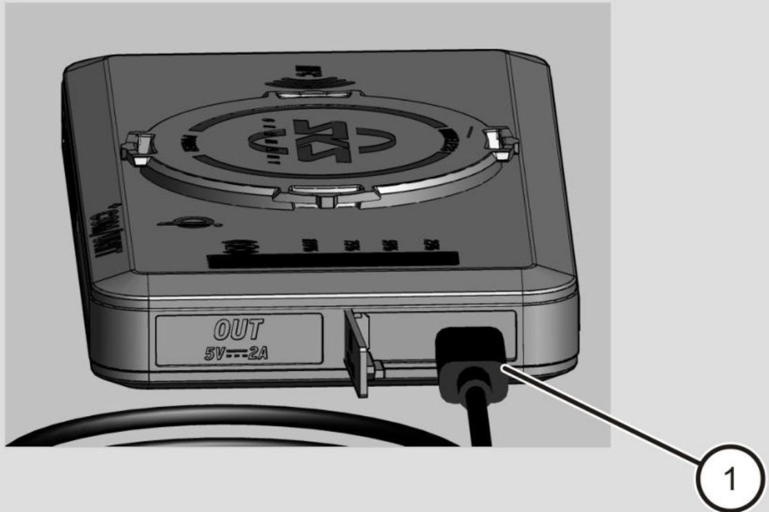
Wenn die Batterie der +COM/UNIT komplett aufgeladen ist, leuchten alle vier orangenen LEDs. Die voraussichtliche Ladedauer beträgt ca. 6 Stunden (abhängig vom Ladegerät).
