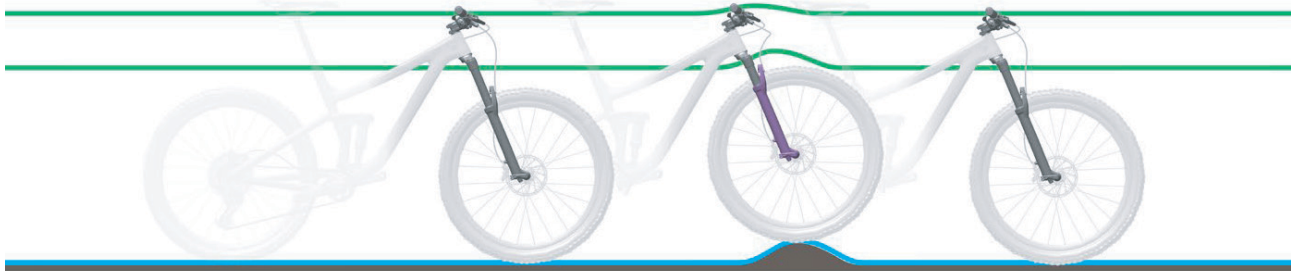
Abbildung 7: Optimales Fahrverhalten der Gabel bei Unebenheiten
