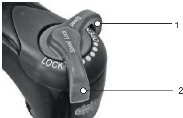
Abbildung 71: Suntour-Druckstufedämpfer in offener (1) und geschlossener (2) Position
