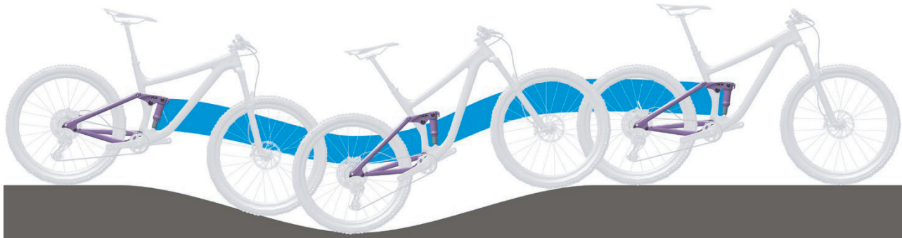
Abbildung 84: Optimales Fahrverhalten des Hinterbau-Dämpfers im hügeligen Gelände
