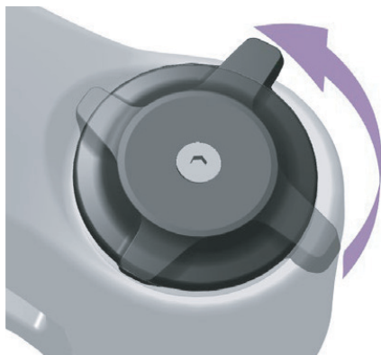
Abbildung 151: Druckstufeneinsteller weicher einstellen
