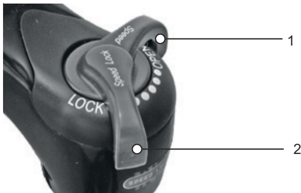
Abbildung 73: Suntour-Druckstufedämpfer in offener (1) und geschlossener (2) Position
