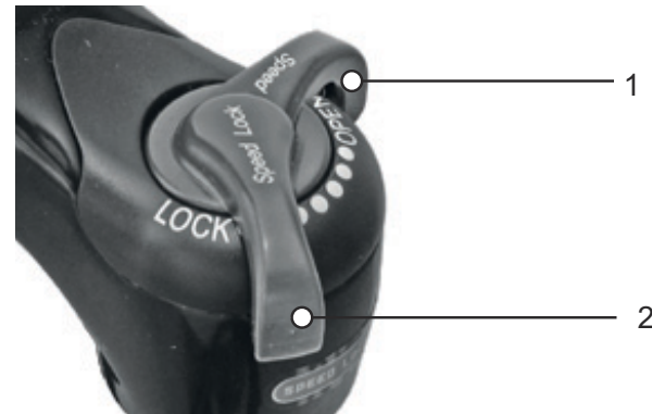
Abbildung 62: Suntour-Druckstufendämpfer in offener (1) und geschlossener (2) Position
