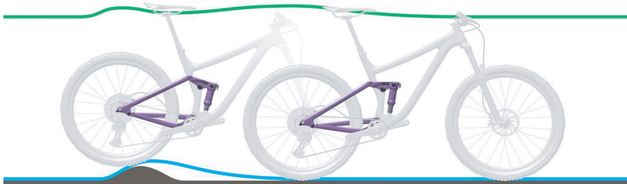
Abbildung 158: Zu harte Dämpfung des Hinterbau-Dämpfers bei Unebenheiten
