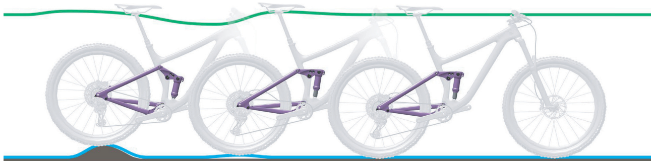
Abbildung 152: Zu schnelles Ausfedern des Hinterbau-Dämpfers
