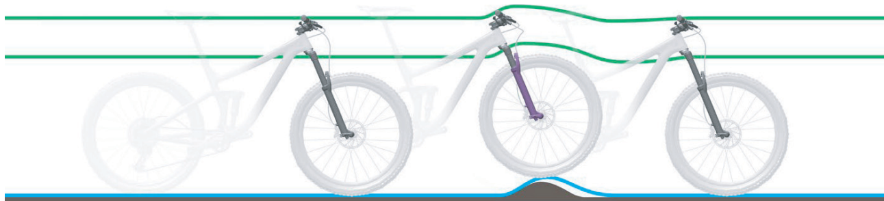
Abbildung 150: Zu harte Dämpfung der Federgabel bei Unebenheiten
