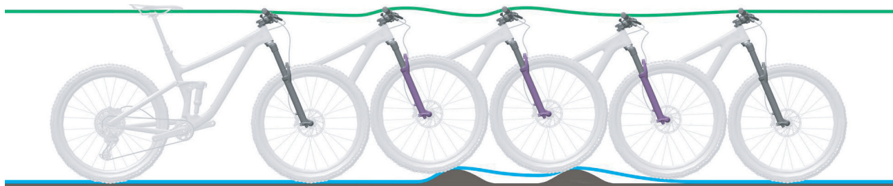
Abbildung 68: Zu langsames Ausfedern der Federgabel
