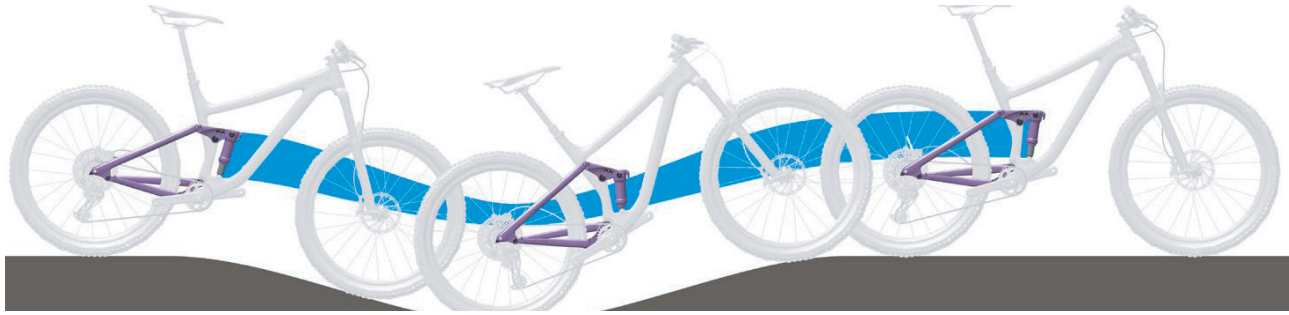
Abbildung 156: Zu weiche Federung des Hintebau-Dämpfers am Berg
