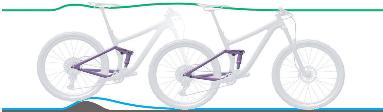
Abbildung 80: Zu harte Dämpfung des Hinterbau-Dämpfers bei Unebenheiten
