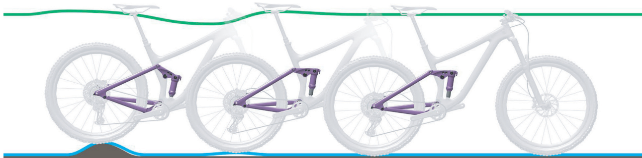
Abbildung 74: Zu schnelles Ausfedern des Hinterbau-Dämpfers
