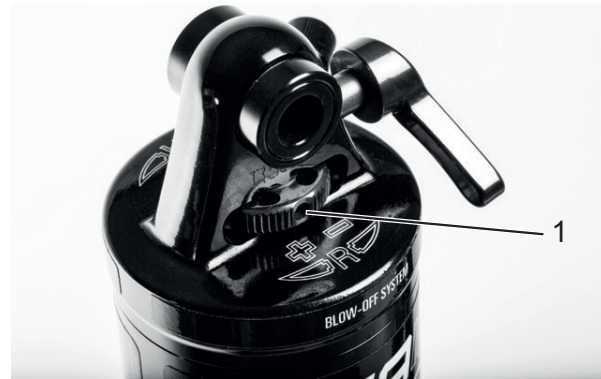
Abbildung 81: Suntour-Zugstufeneinsteller Rad (1) am Hinterbau-Dämpfer
