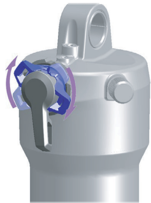
Abbildung 157: Druckstufeneinsteller härter einstellen
