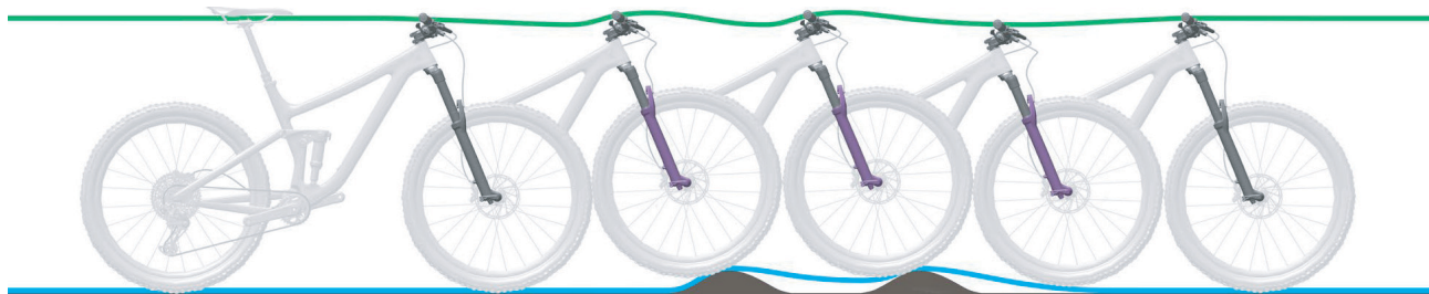
Abbildung 146: Zu langsames Ausfedern der Federgabel
