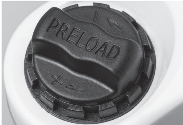
Abbildung 75: Einstellrad SAG auf der Krone der Federgabel
