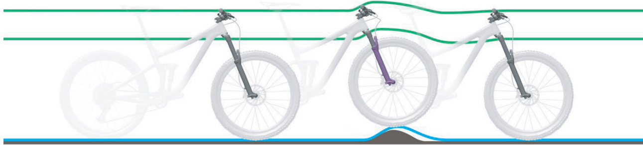
Abbildung 72: Zu harte Dämpfung der Federgabel bei Unebenheiten
