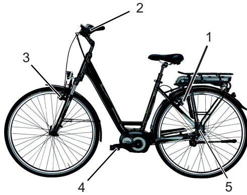
Abbildung 18: Bremsystem mit einer Rücktrittbremse, Beispiel
