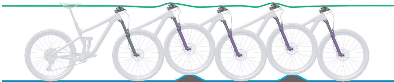
Abbildung 78: Optimales Fahrverhalten der Gabel
