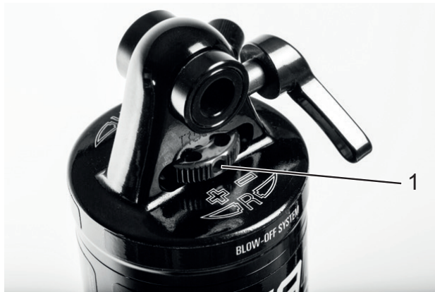
Abbildung 77: Zugstufendämpfer gegen den Uhrzeigersinn drehen
