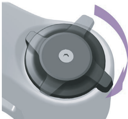
Abbildung 149: Druckstufeneinsteller härter einstellen
