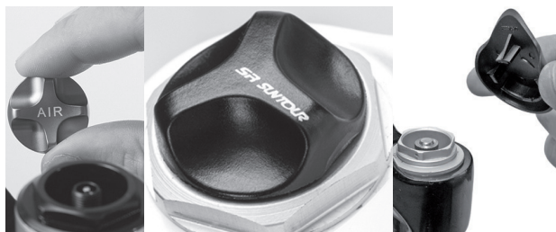
Abbildung 38: Schraubabdeckungen in unterschiedlichen Ausführungen
