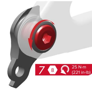
Instale a anilha SUD/UDH específica para o quadro. Instale o perno SUD/UDH através da anilha e para dentro dos fios de rosca do suspensor SUD/UDH.
