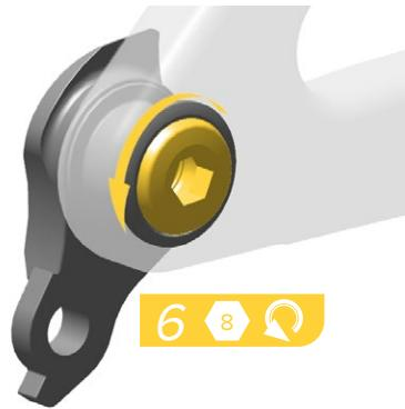
Installez la rondelle UDH spécifique à votre cadre. Insérez la vis UDH à travers la rondelle et dans le filetage de la patte UDH.
