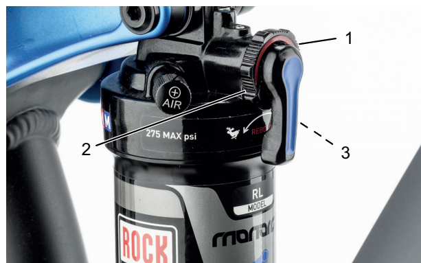
Abbildung 88: Härte des Zugstufen-Dämpfers am Einstellrad (1) des Hinterbau-Dämpfer einstellen
