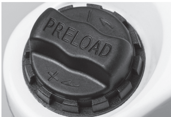
Abbildung 70: Einstellrad des Negativfederwegs auf der Krone der Federgabel
