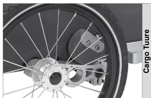
Wartungsfreie AirPad® -Federung mit Sylomer® (Cargo Tuure)
