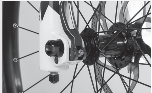
Abbildung 41: Perfekte Lage des Spannhebels
