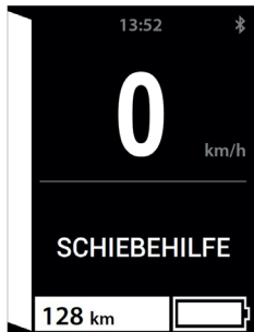
Bild 10: Schiebehilfe aktiv Figure 10: Pushing aid active
