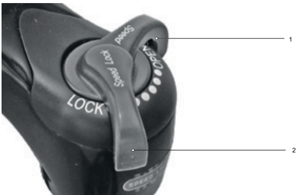
Abbildung 265: Druckstufeneinsteller härter einstellen
