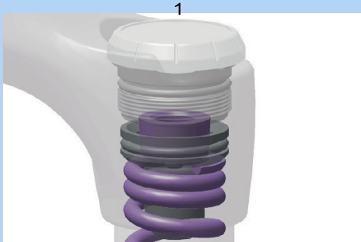
Abbildung 131: Vorspannungseinstellring hinein und heraus drehen.
