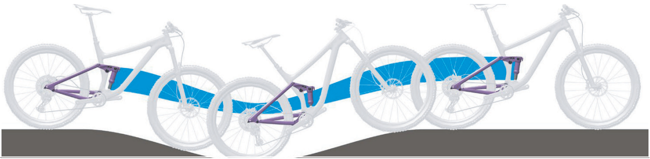
Abbildung 288: Zu weiche Federung des Hinterbau-Dämpfers am Berg
