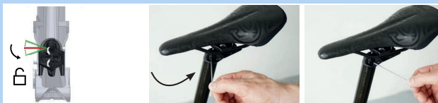
Abbildung 198: Höhenverstellungsbetätigung in „Geöffnete Stellung“ bringen
