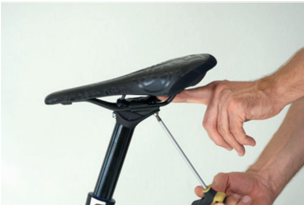
Abbildung 106: Hintere Schraube lockern
