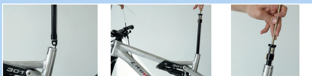
Abbildung 226: Kartusche Ventildeckel befestigen
