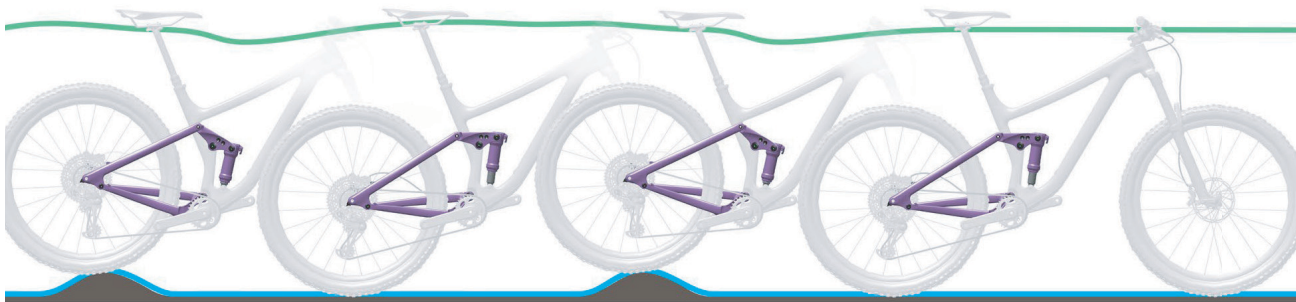
Abbildung 147: Optimales Fahrverhalten des Hinterbau-Dämpfers
