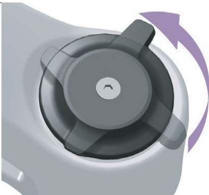
Abbildung 275: Druckstufeneinsteller weicher einstellen
