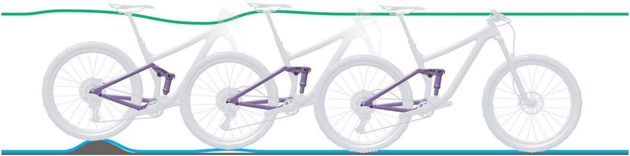
Abbildung 276: Zu schnelles Ausfedern des Hinterbau-Dämpfers
