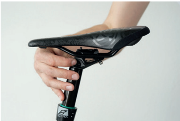
Abbildung 103: Sattelneigung am Einstellrad einstellen
