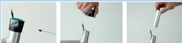
Abbildung 206: Außenhülse und Gleitbuchse ausbauen
