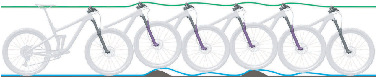
Abbildung 260: Zu schnelles Ausfedern der Federgabel
