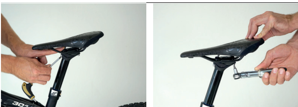
Abbildung 101: Vordere und hintere Schraube feststellen
