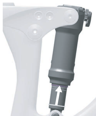
Abbildung 143: O-Ring am Hinterbau-Dämpfer verschieben
