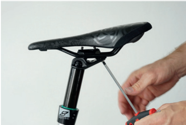
Abbildung 108: Hintere Schraube lockern
