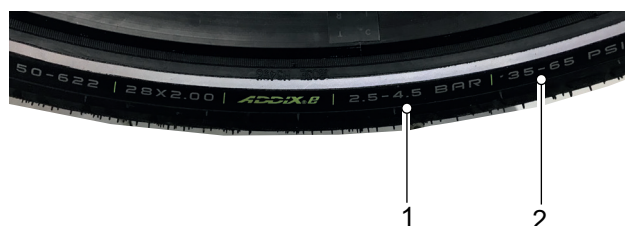
Abbildung 185: Fülldruck in bar (1) und psi (2)
