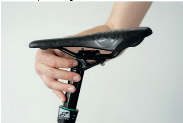
Abbildung 109: Sattelneigung am Einstellrad einstellen
