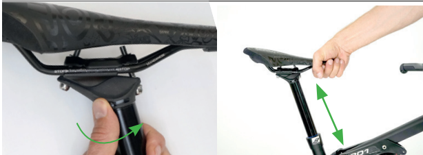
Abbildung 96: Höhe der Sattelstütze einstellen
