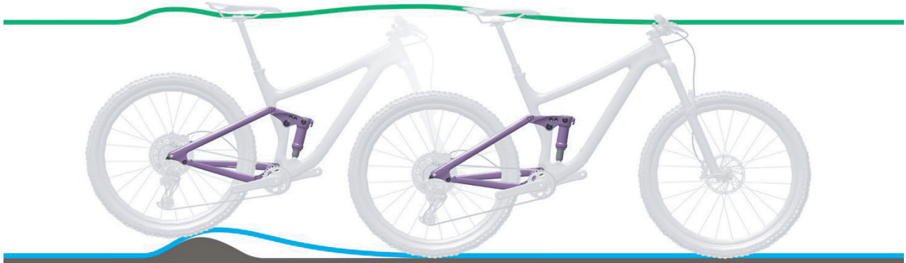
Abbildung 282: Zu harte Dämpfung des Hinterbau-Dämpfers bei Unebenheiten
