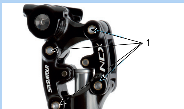
Abbildung 197: Schmierpunkte SR Suntour Feder-Sattelstütze
