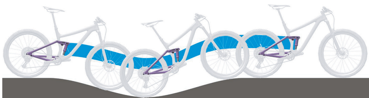
Abbildung 23: Optimales Fahrverhalten des Hinterbau-Dämpfers im hügeligen Gelände
