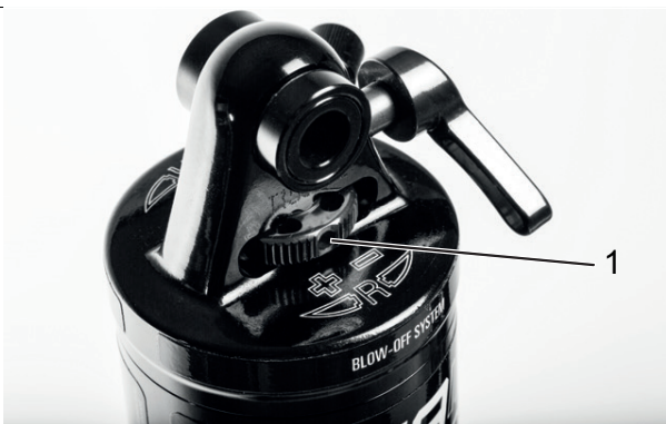
Abbildung 279: Suntour-Zugstufeneinsteller Rad (1) am Hinterbau-Dämpfer
