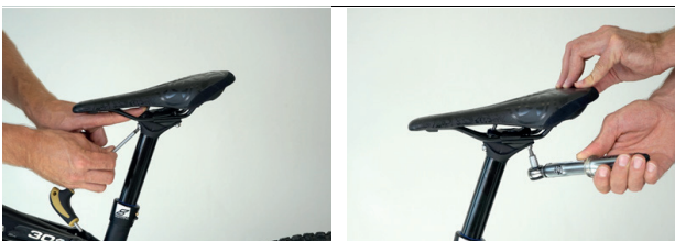
Abbildung 107: Vordere und hintere Schraube feststellen
