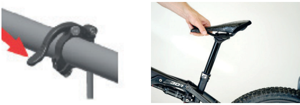
Abbildung 95: Hydraulische Gasdruckfeder ausfahren
