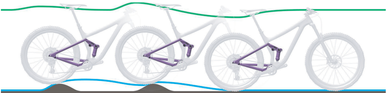
Abbildung 278: Zu langsames Ausfedern des Hinterbau-Dämpfers
