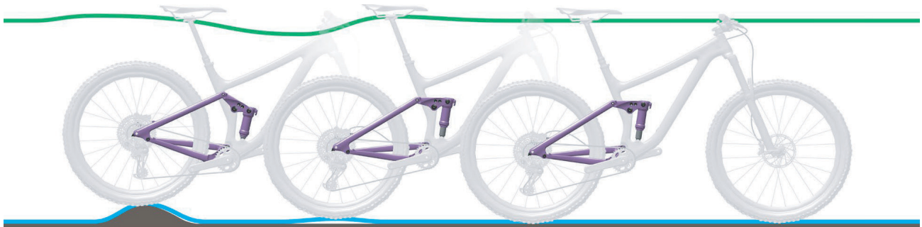
Abbildung 284: Zu schnelles Ausfedern des Hinterbau-Dämpfers
