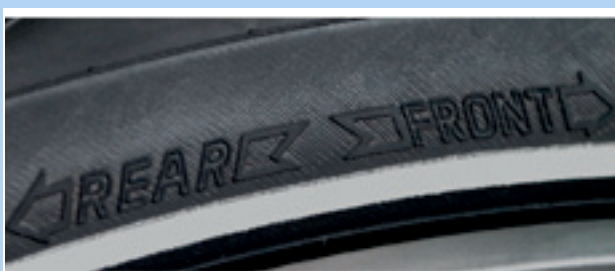
Abbildung 61: Laufrichtungspfeil auf MTB Reifen
