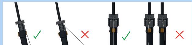
Abbildung 176: Korrekter und falscher Bowdenzug
