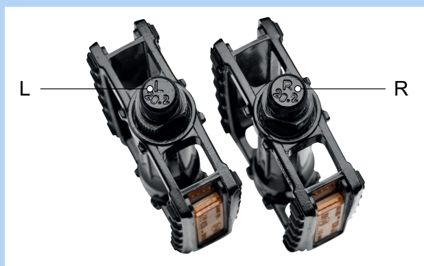
Abbildung 85: Beispiel Kennzeichnung von Pedalen
