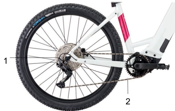
Abbildung 29: Schema Kettenantrieb mit Kettenschaltung
