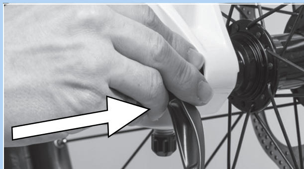
Abbildung 82: Schnellspanner in Pfeilrichtung einschieben
