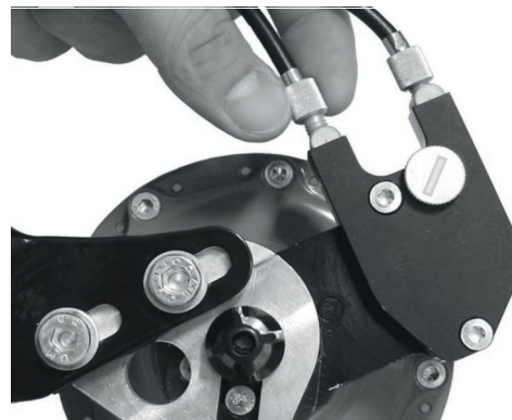
Abbildung 156: ROHLOFF-Naben Versionen mit externer Schaltansteuerung haben die Zugeinsteller an der Seilbox, die sich auf der linken Seite befindet
