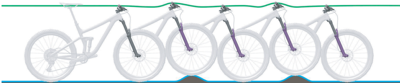
Abbildung 11: Optimales Fahrverhalten der Gabel
