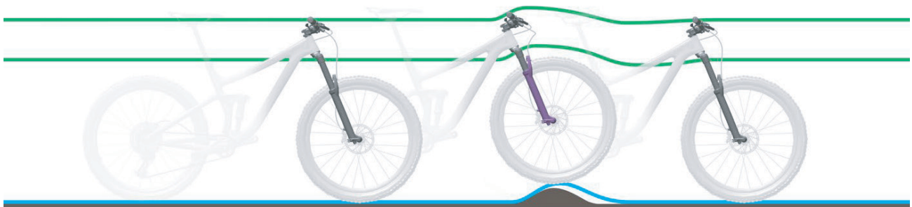
Abbildung 230: Zu harte Dämpfung der Federgabel bei Unebenheiten
