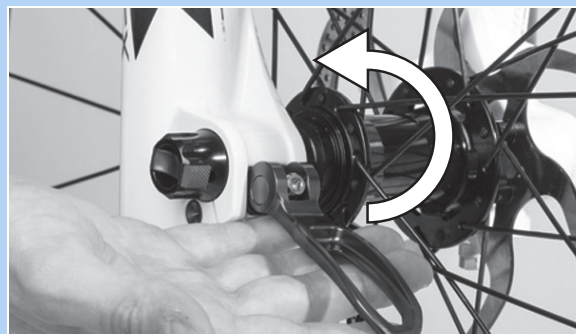
Abbildung 78: Schnellspannhebel in Pfeilrichtung drücken
