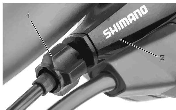
Abbildung 151: Einstellhülse (1) der einzügigen, seilzugbetätigten Gangschaltung mit Schalthebelgehäuse (2), Beispiel
