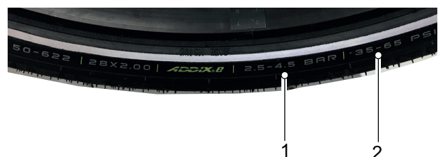
Abbildung 143: Fülldruck in bar (1) und psi (2)
