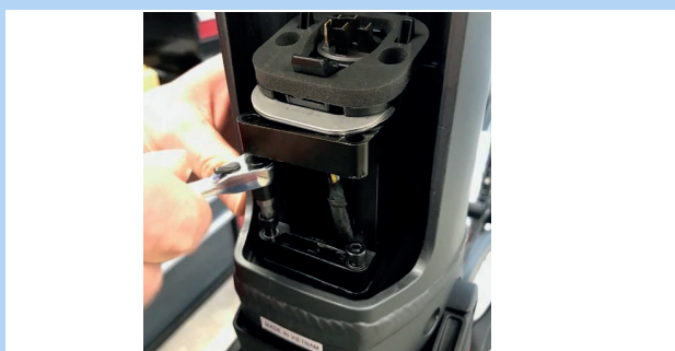
Abbildung 53: 4 mm 6-Kant-Schrauben entfernen
