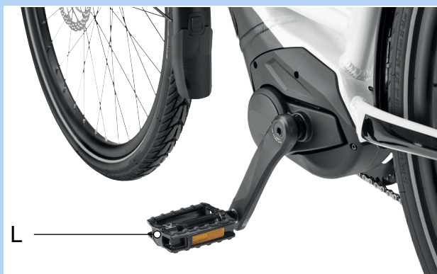
Abbildung 82: L-Pedal im linken Kurbelarm
