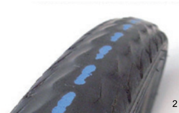
Abbildung 144: Reifen ohne Profil, der noch gefahren werden kann (1), und Reifen mit durchscheinendem Pannenschutz (2), der gewechselt werden muss
