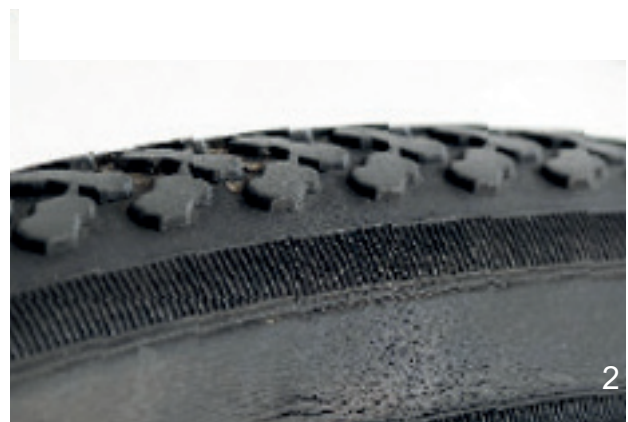
Abbildung 145: Beispiele für Ermüdungsrisse (1) und Alterungsrisse (2)
