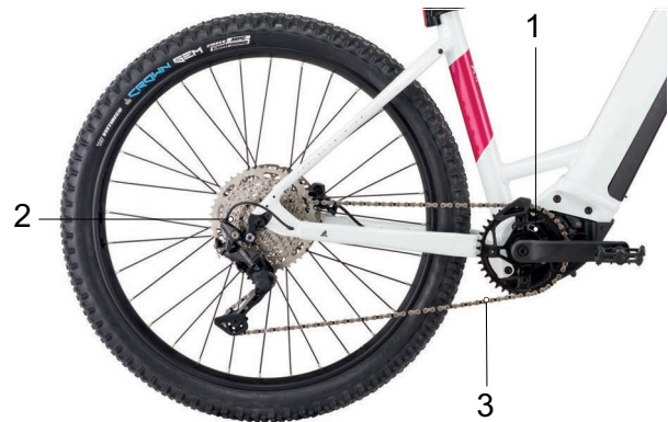
Abbildung 29: Schema Kettenantrieb mit Kettenschaltung
