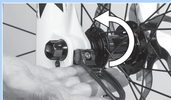
Abbildung 72: Schnellspannhebel in Pfeilrichtung drücken
