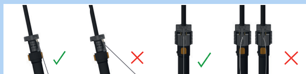
Abbildung 184: Korrekter und falscher Bowdenzug
