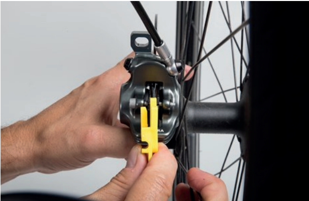
Abbildung 206: Bremsbelag im eingebauten Zustand mithilfe der Transportsicherung prüfen
