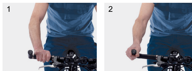
Abbildung 181: Griffpositionen am Bar End
