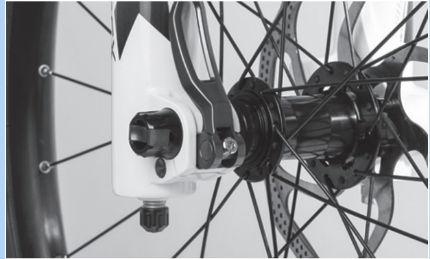
Abbildung 235: Spannkraft des Schnellspanners einstellen
