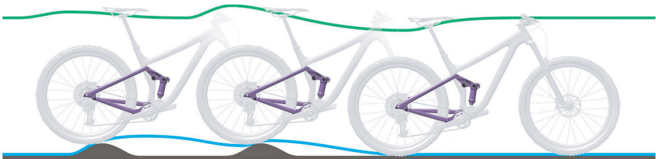
Abbildung 265: Zu langsames Ausfedern des Hinterbau-Dämpfers
