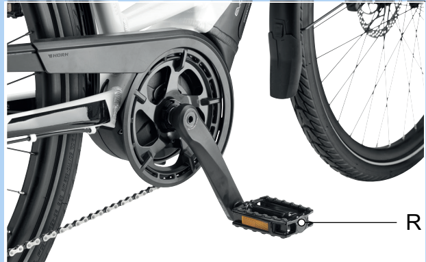
Abbildung 97: R-Pedal im rechten Kurbelarm
