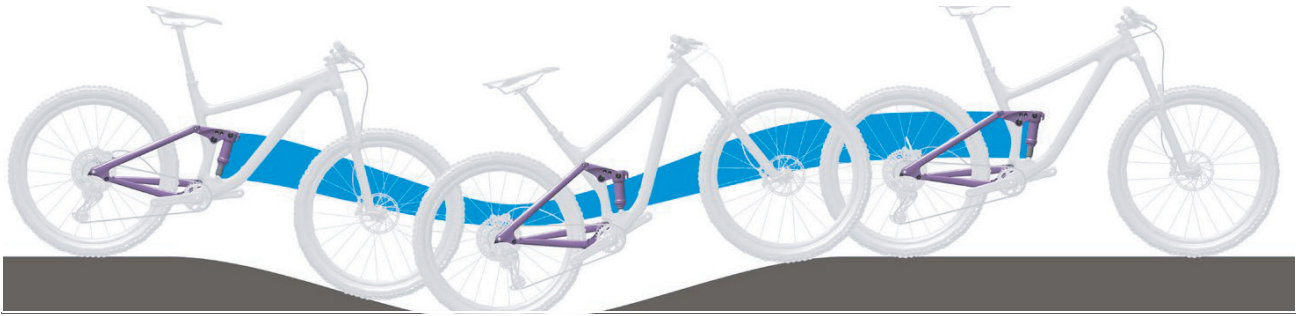
Abbildung 259: Zu weiche Federung des Hinterbau-Dämpfers am Berg
