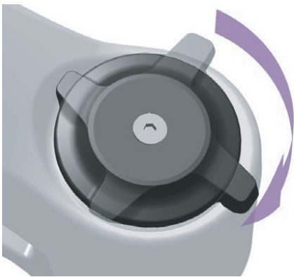
Abbildung 252: Druckstufeneinsteller härter einstellen
