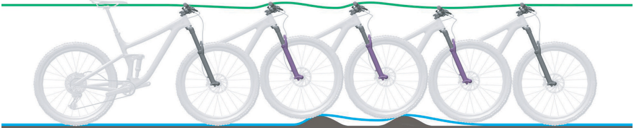
Abbildung 249: Zu langsames Ausfedern der Federgabel
