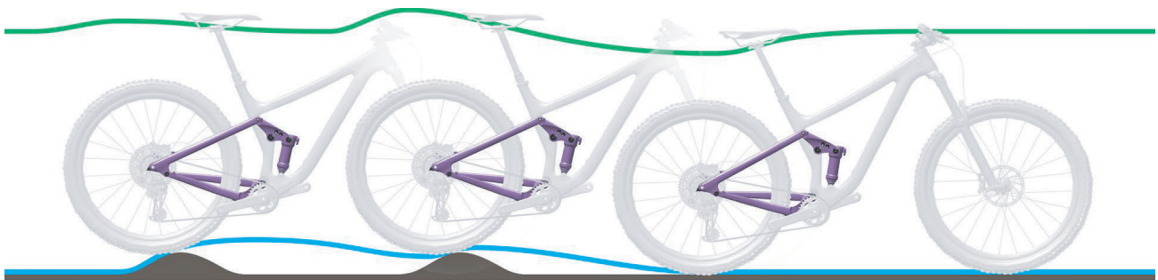
Abbildung 257: Zu langsames Ausfedern des Hinterbau-Dämpfers
