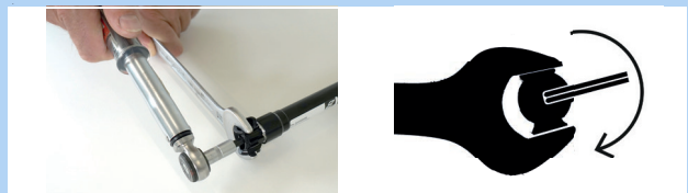
Abbildung 163: Im Uhrzeigersinn einstellen
