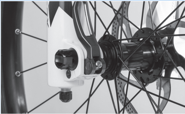
Abbildung 138: Spannkraft des Schnellspanners einstellen
