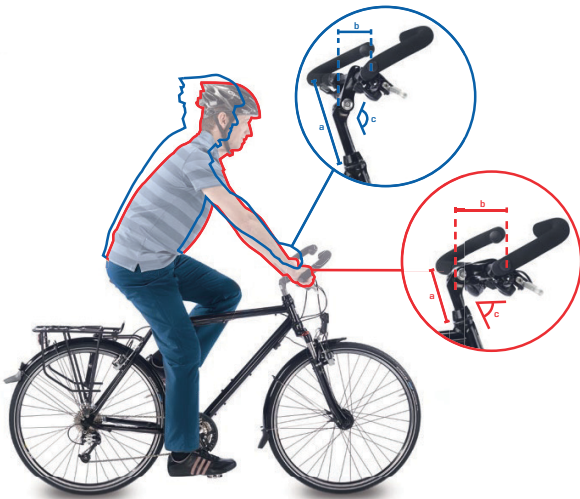
Abbildung 84: Citybike (blau) und Trekkingrad Position (rot) durch Winkeländerung
