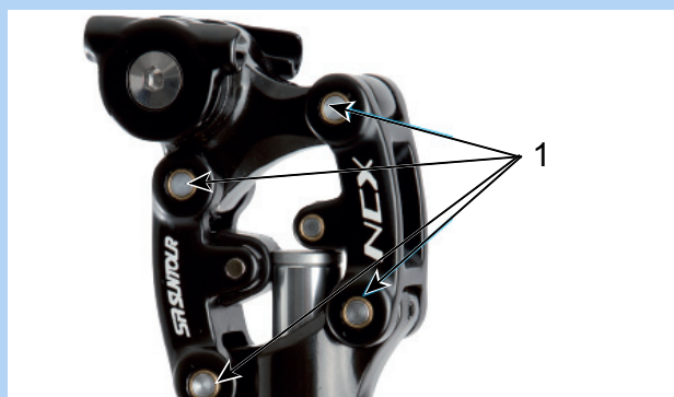
Abbildung 140: Schmierpunkte SR Suntour Feder-Sattelstütze
