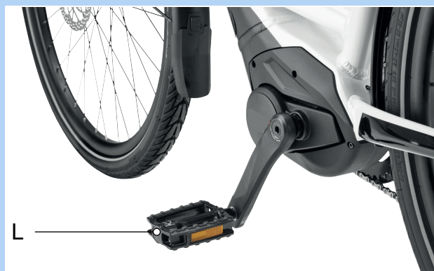
Abbildung 66: L-Pedal im linken Kurbelarm
