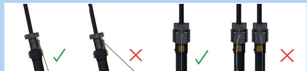
Abbildung 168: Korrekter und falscher Bowdenzug
