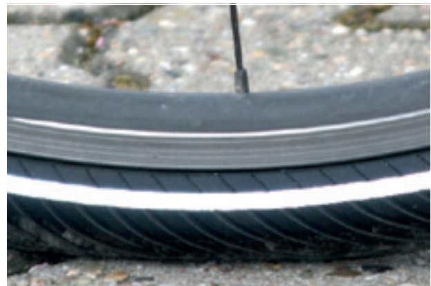
Abbildung 86: Korrekter Fülldruck. Der Reifen ist unter der Last des Körpergewichts kaum verformt.
