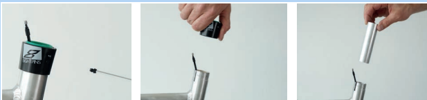
Abbildung 149: Außenhülse und Gleitbuchse ausbauen
