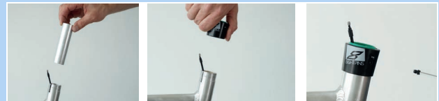
Abbildung 165: Gleitbuchse und Außenhülse einbauen
