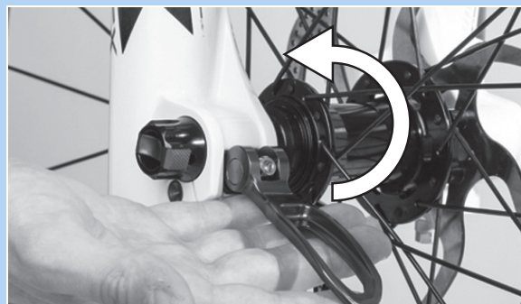
Abbildung 58: Schnellspannhebel in Pfeilrichtung drücken
