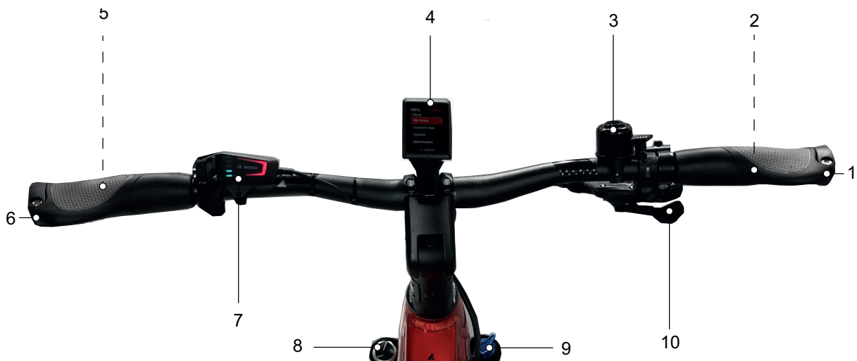
Abbildung 34: Detailansicht Lenker mit BOSCH Kiox 300, Beispiel
