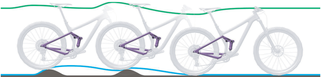
Abbildung 258: Zu langsames Ausfedern des Hinterbau-Dämpfers
