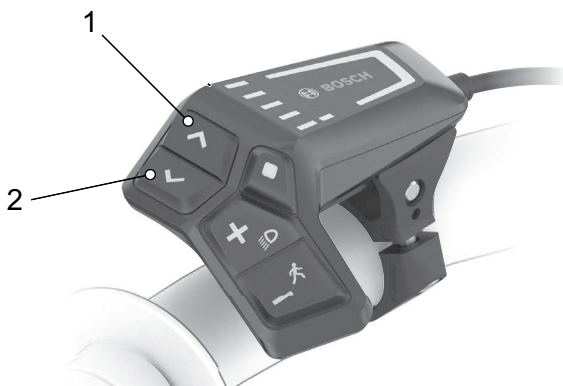
Abbildung 141: Lage Helligkeit erhöhen-Taste (2) und Helligkeit vermindern-Taste (1)
