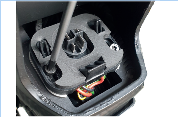
Abbildung 49: Akkuhalter Schrauben lösen
