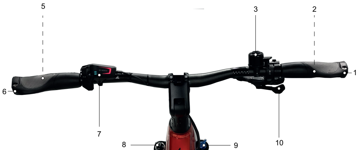
Abbildung 43: Detailansicht Lenker mit BOSCH Kiox 300, Beispiel
