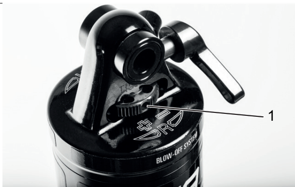
Abbildung 251: Suntour-Zugstufeneinsteller Rad (1) am Hinterbau-Dämpfer
