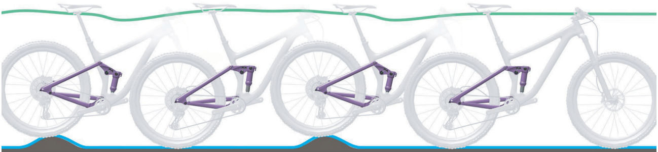
Abbildung 15: Optimales Fahrverhalten des Hinterbau-Dämpfers
