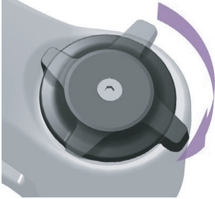
Abbildung 149: Druckstufeneinsteller härter einstellen
