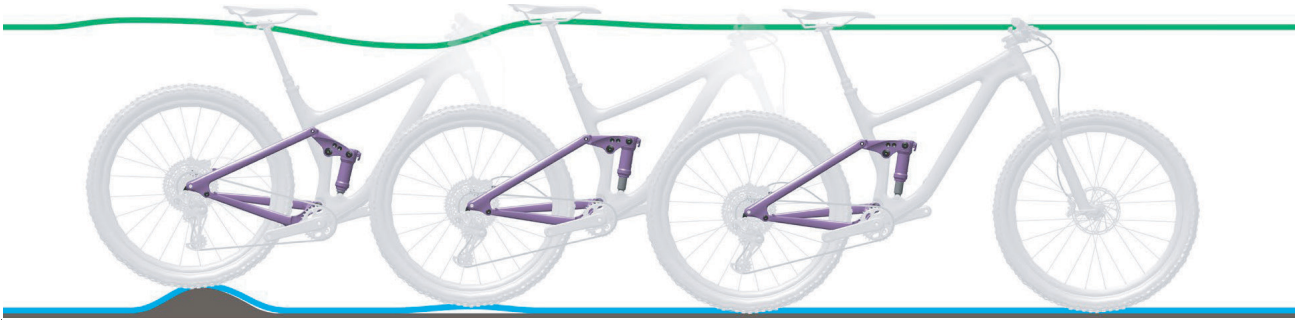
Abbildung 256: Zu schnelles Ausfedern des Hinterbau-Dämpfers
