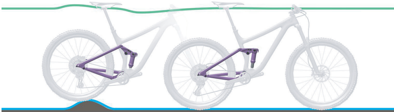
Abbildung 121: Optimales Fahrverhalten des Hinterbau-Dämpfers bei Unebenheiten
