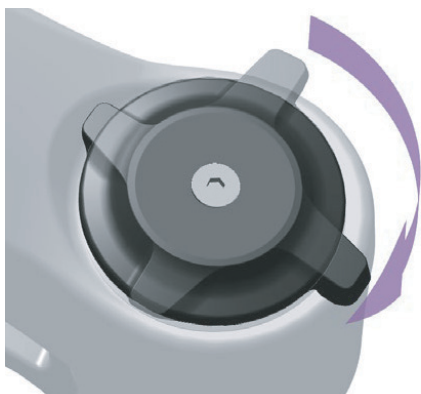
Abbildung 245: Druckstufeneinsteller härter einstellen
