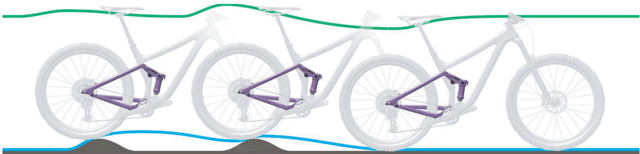
Abbildung 250: Zu langsames Ausfedern des Hinterbau-Dämpfers
