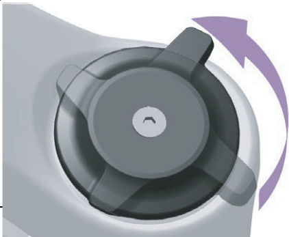
Abbildung 150: Druckstufeneinsteller weicher einstellen
