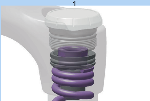
Abbildung 103: Vorspannungseinstellring hinein und heraus drehen.
