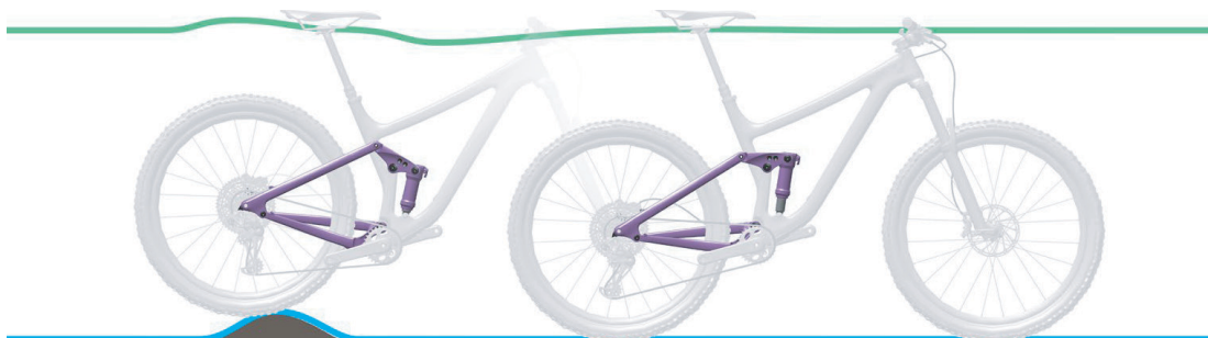
Abbildung 12: Optimales Fahrverhalten des Hinterbau-Dämpfers bei Unebenheiten
