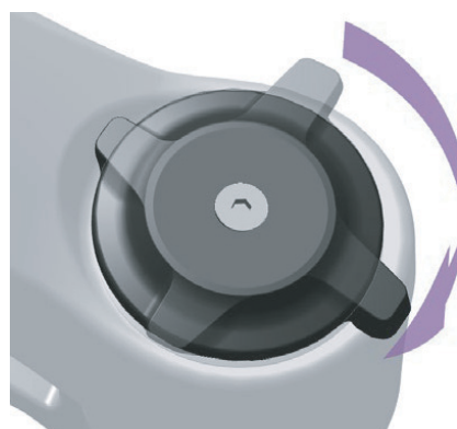
Abbildung 78: Druckstufeneinsteller härter einstellen
