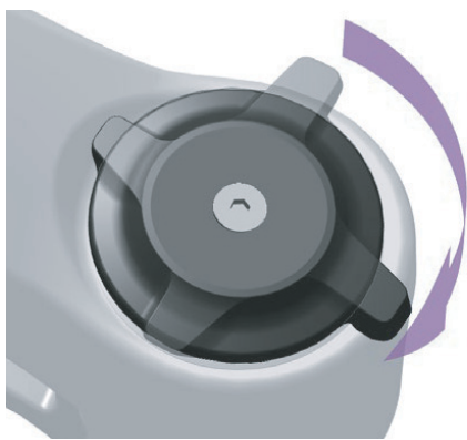
Abbildung 94: Druckstufeneinsteller härter einstellen
