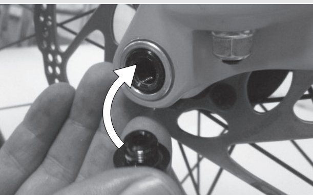
Abbildung 24: Schnellspannhebel in Achse schieben
