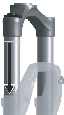
Abbildung 57: O-Ring an der Federgabel verschieben
