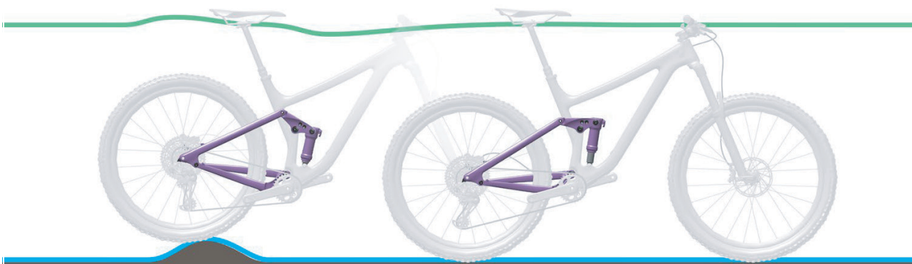
Abbildung 69: Optimales Fahrverhalten des Hinterbau-Dämpfers bei Unebenheiten
