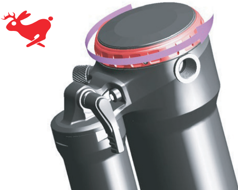
Abbildung 100: Zugstufendämpfer in Richtung Hase drehen
