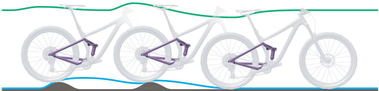
Abbildung 99: Zu langsames Ausfedern des Hinterbau-Dämpfers
