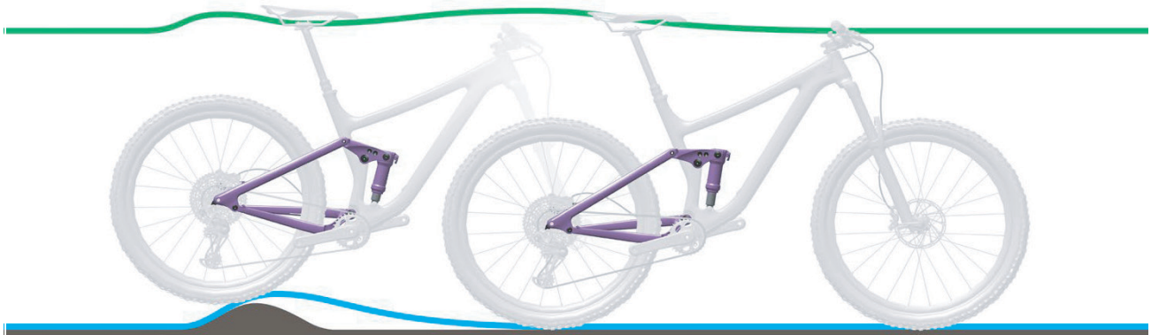
Abbildung 103: Zu harte Dämpfung des Hinterbau-Dämpfers bei Unebenheiten
