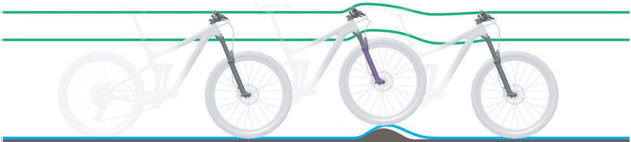
Abbildung 95: Zu harte Dämpfung der Federgabel bei Unebenheiten
