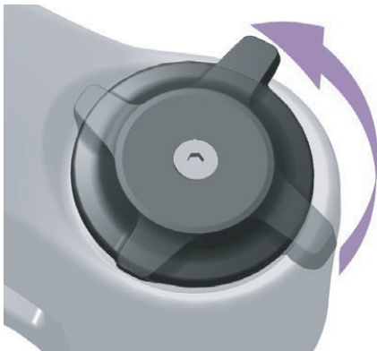
Abbildung 96: Druckstufeneinsteller weicher einstellen
