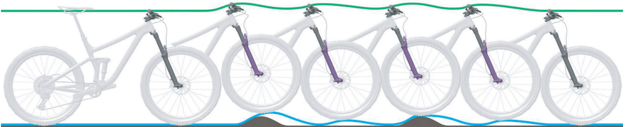
Abbildung 89: Zu schnelles Ausfedern der Federgabel
