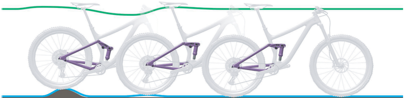
Abbildung 97: Zu schnelles Ausfedern des Hinterbau-Dämpfers
