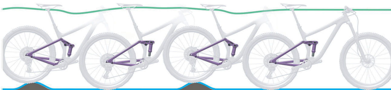
Abbildung 62: Optimales Fahrverhalten des Hinterbau-Dämpfers
