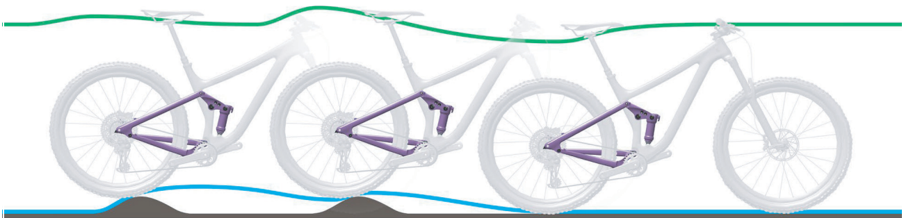
Abbildung 99: Zu langsames Ausfedern des Hinterbau-Dämpfers
