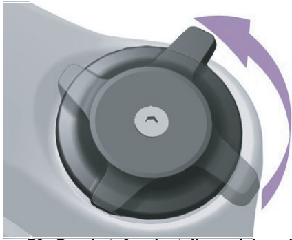
Abbildung 79: Druckstufeneinsteller weicher einstellen
