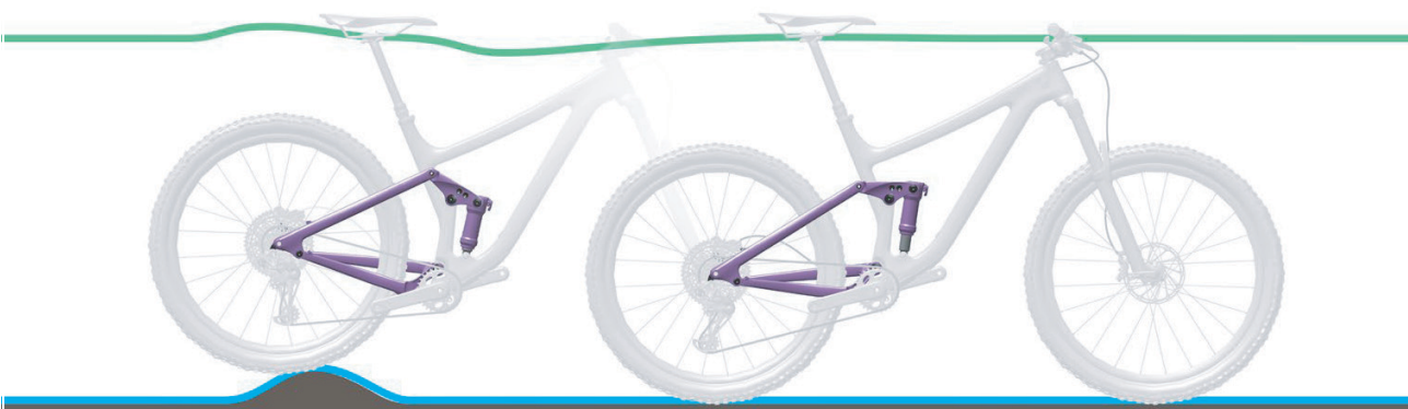
Abbildung 69: Optimales Fahrverhalten des Hinterbau-Dämpfers bei Unebenheiten
