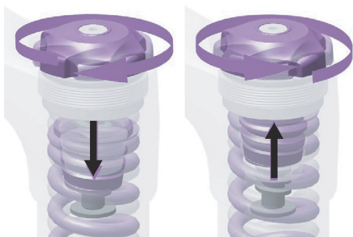
Abbildung 55: Vorspannungseinstellung herein und heraus drehen.
