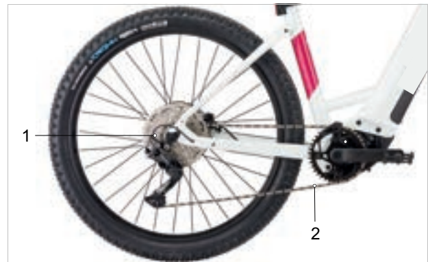
Abbildung 47: Schema Kettenantrieb mit Kettenschaltung
