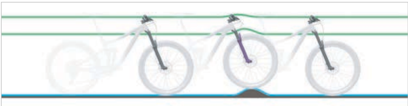
Abbildung 158: Hart und weich eingestellter Druckstufen-Dämpfer
