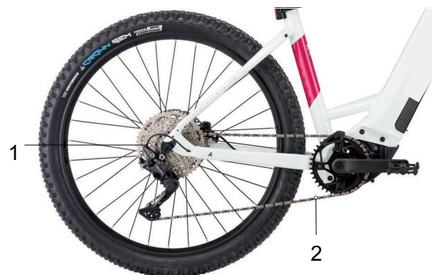
Abbildung 27: Schema Kettenantrieb mit Kettenschaltung
