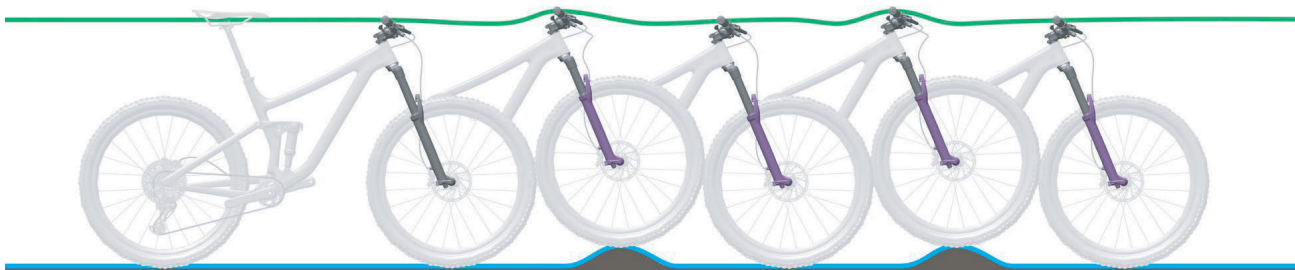
Abbildung 97: Optimales Fahrverhalten der Gabel
