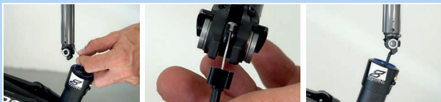
Abbildung 199: Sattelstütze aufhängen und einschieben
