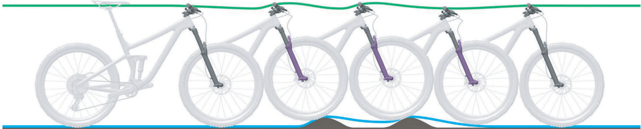
Abbildung 205: Zu langsames Ausfedern der Federgabel
