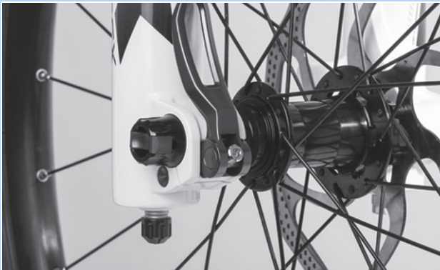
Abbildung 138: Spannkraft des Schnellspanners einstellen
