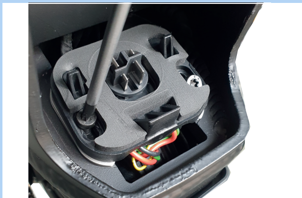
Abbildung 46: Akkuhalter Schrauben lösen
