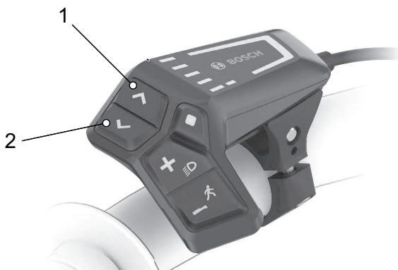
Abbildung 114: Lage Helligkeit erhöhen-Taste (2) und Helligkeit vermindern-Taste (1)
