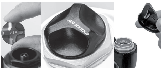
Abbildung 96: Schraubabdeckungen in unterschiedlichen Ausführungen
