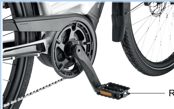
Abbildung 67: R-Pedal im rechten Kurbelarm
