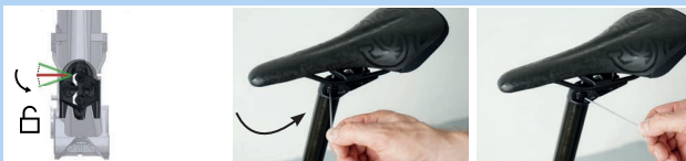
Abbildung 141: Höhenverstellungsbetätigung in „Geöffnete Stellung“ bringen
