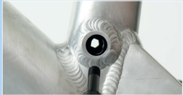
Abbildung 201: Loch der Postpin Schnittstelle
