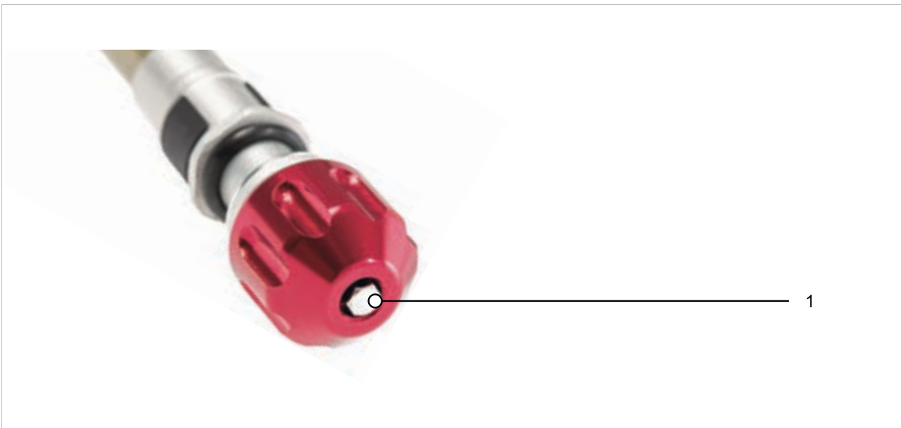
Abbildung 228: Beispiel SR SUNTOUR Zugstufen-Schraube (1)
