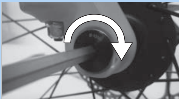
Abbildung 84: Achse in Pfeilrichtung anziehen
