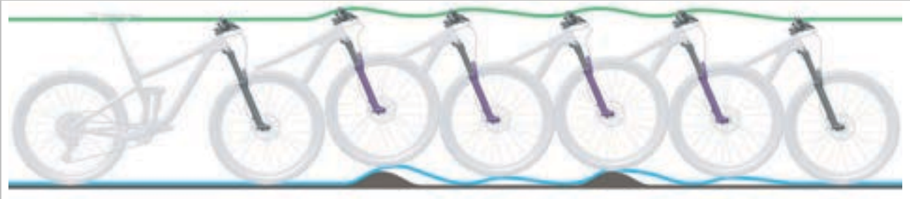
Abbildung 227: Zu schnelles Ausfedern der Federgabel
