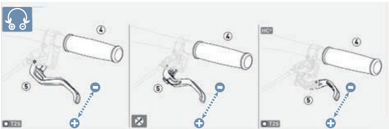
Abbildung 132: Griffweite Handbremse MAGURA Scheibenbremse einstellen
