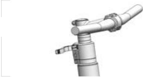
Abbildung 168: Beispiel All Up mit geöffnetem Vorbau-Spannhebel
