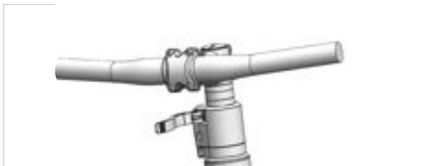
Abbildung 157: Beispiel All Up mit geöffnetem Vorbau-Spannhebel
