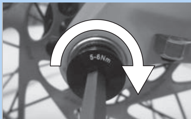
Abbildung 86: Sicherungsschraube anziehen
