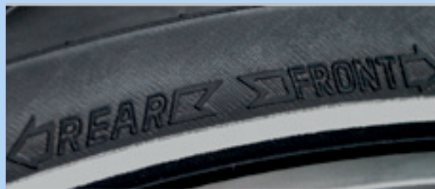
Abbildung 98: Laufrichtungspfeil auf MTB-Reifen
