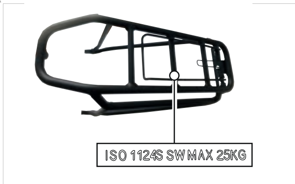
Abbildung 160: Auf dem Gepäckträger ist seine maximale Tragfähigkeit ausgewiesen
