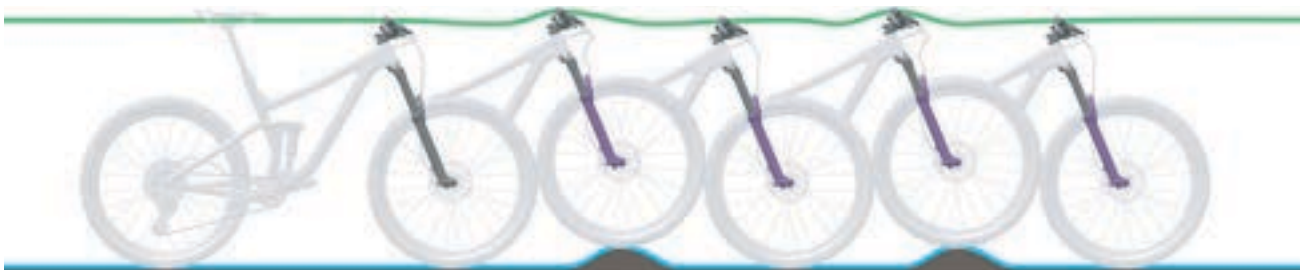
Abbildung 133: Optimales Fahrverhalten der Gabel
