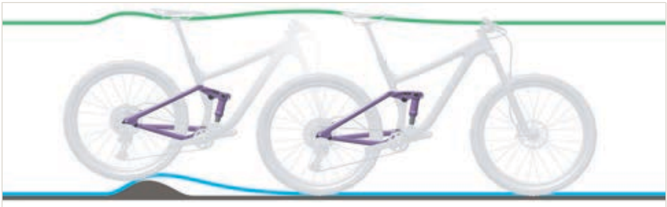
Abbildung 269: Zu harte Dämpfung des Hinterbau-Dämpfers bei Unebenheiten
