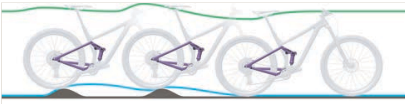
Abbildung 273: Zu langsames Ausfedern des Hinterbau-Dämpfers
