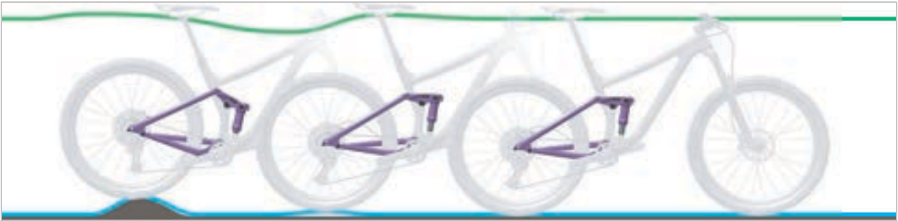
Abbildung 255: Zu schnelles Ausfedern des Hinterbau-Dämpfers
