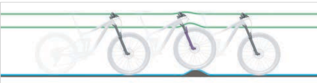
Abbildung 167: Hart und weich eingestellter Druckstufen-Dämpfer
