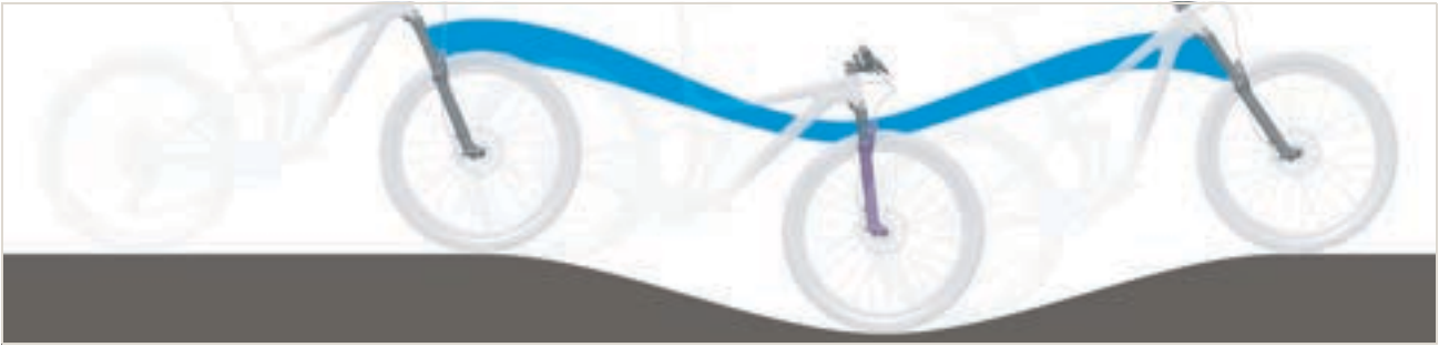
Abbildung 249: Zu weiche Federung der Federgabel am Berg
