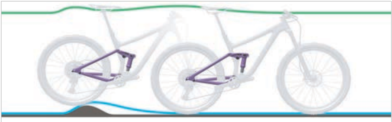
Abbildung 261: Zu harte Dämpfung des Hinterbau-Dämpfers bei Unebenheiten
