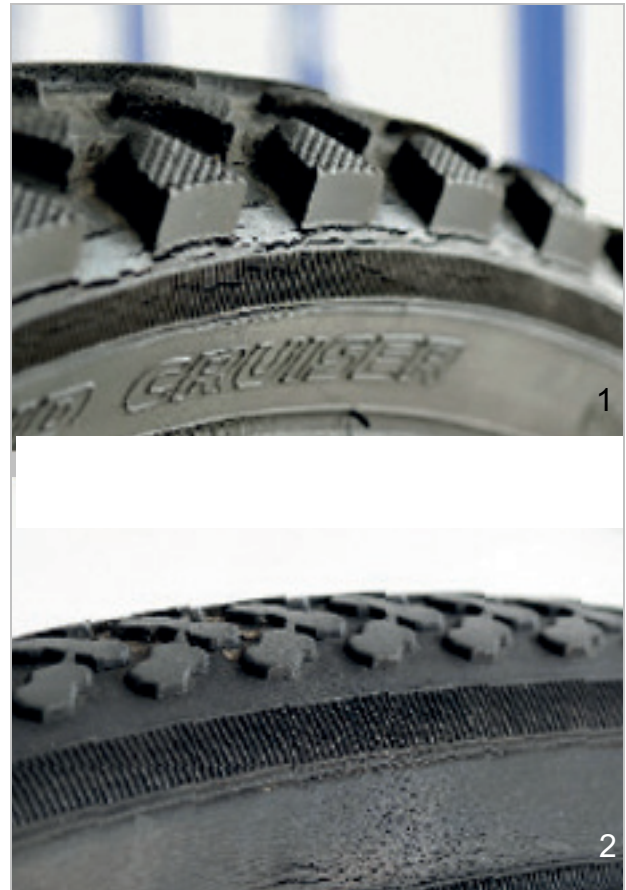
Abbildung 198: Beispiele für Ermüdungsrisse (1) und Alterungsrisse (2)
