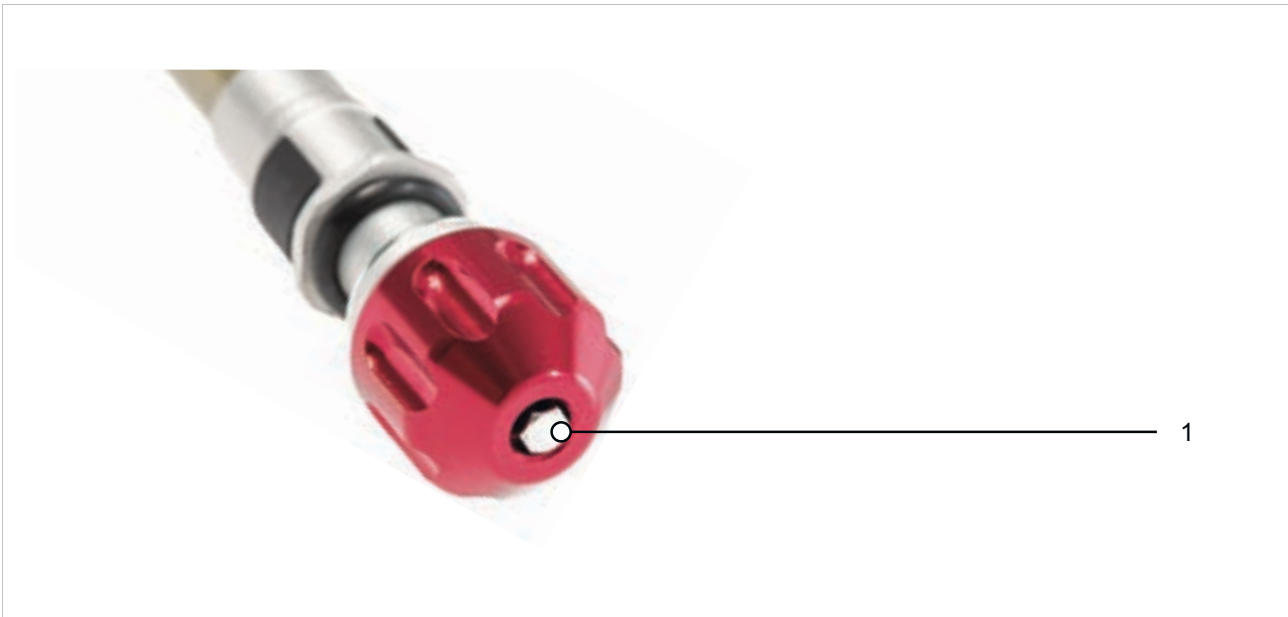
Abbildung 147: Beispiel SR SUNTOUR Zugstufen-Einsteller (Gabel) (1)
