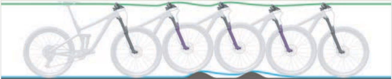
Abbildung 247: Zu langsames Ausfedern der Federgabel
