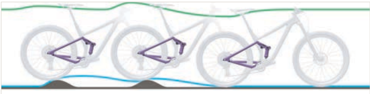
Abbildung 265: Zu langsames Ausfedern des Hinterbau-Dämpfers
