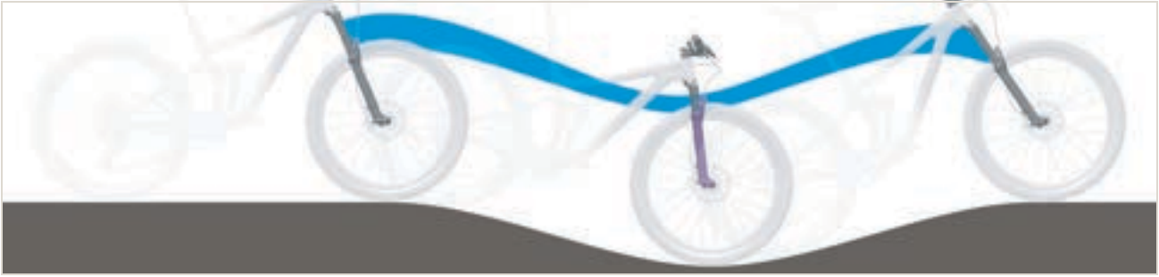
Abbildung 235: Zu weiche Federung der Federgabel am Berg
