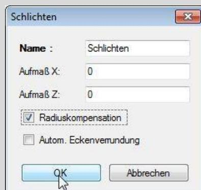
Bei Bedarf kann die Radiuskompensation an- oder abgewählt werden.
