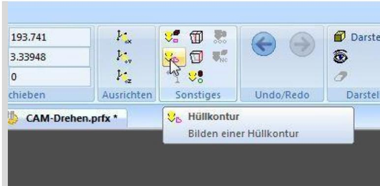
Nun kann mit einem Klick auf Hüllkontur eine Rotationsgeometrie des Modells in das Ebenfenster übertragen werden.
