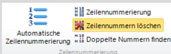
Mit dieser Funktion "Zeilennummern löschen" in der Werkzeugleiste werden alle NC-Sätze mit „N...“ am Zeilenanfang aus dem NC-Programm entfernt.
