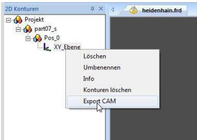
Nun kann mit einem Rechtsklick auf "XY-Ebene" der Punkt "Export CAM" gewählt werden. Mit dieser Funktion wird die Geometrie aus dem Ebenenfenster in NumericNotes übergeben.
