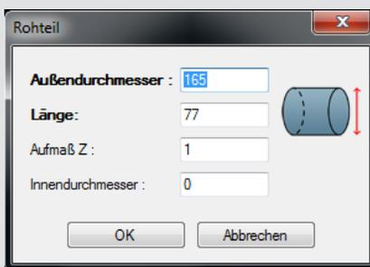
Sind alle Parameter zuvor korrekt im Maschineneinrichteblatt definiert worden, werden diese automatisch in die Maske für die Rohteildefinition eingetragen und können übernommen werden.
