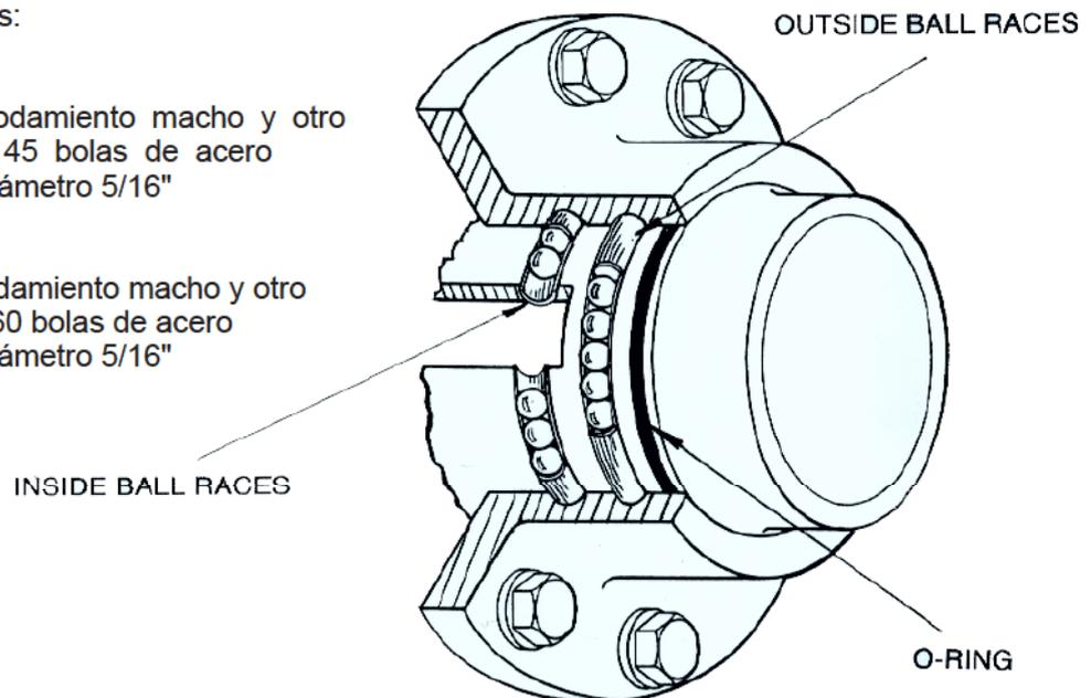
**JUNTAS DE REPUESTO**, desarrolladas específicamente por Gammon para giradores Chiksan-FMC, evitan incluso el goteo o fuga del sistema aunque no esté presurizado. En lugar de una simple junta moldeada, nuestro sistema utiliza dos o-rings de viton que sellan a baja y alta presión el sistema. Incluye un soporte perfectamente mecanizado para los dos o-rings, de manera que en un futuro solo se requerirá la sustitución de dichos o-rings.
