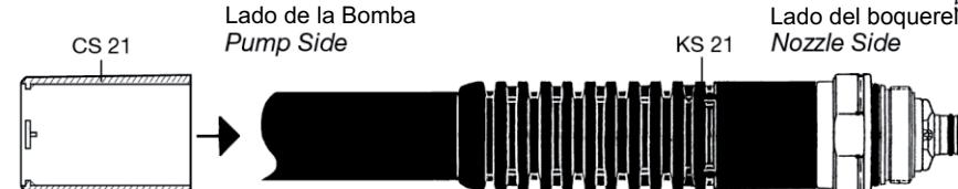
Montaje de la manga de color **CS 21** se efectúa tanto en el acoplamiento de manguera del lado de la bomba, o -tras retirar el casquillo giratorio- en el lado del boquerel.
