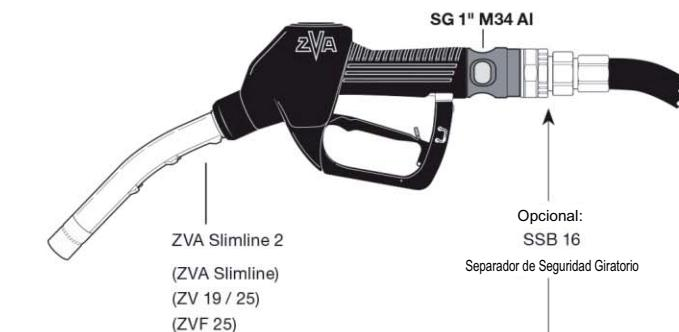
**SG 1" M 34 AI.** Tienen roscas métricas en ambos lados. Se instala entre el boquerel y el girador existente. Siempre encaja, independientemente del tipo de rosca del ensamblaje de manguera. También para re-equipamiento.
