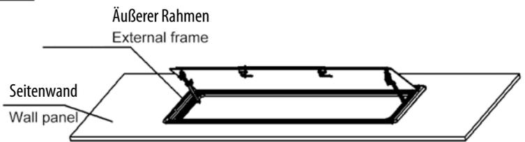
Schritt 2: Tragen Sie Silikon- oder Schaumstoff rund um die Fensterkante auf und montieren Sie das Fenster.
