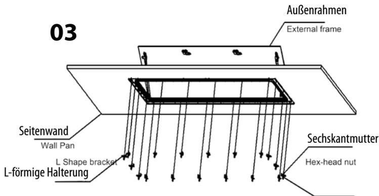
Schritt 3: Befestigen Sie den Winkel (L-Form) auf jedem Gewinde und schrauben Sie dann die Sechskantmutter, stellen Sie sicher, dass Sie diese nicht zu fest ziehen.
