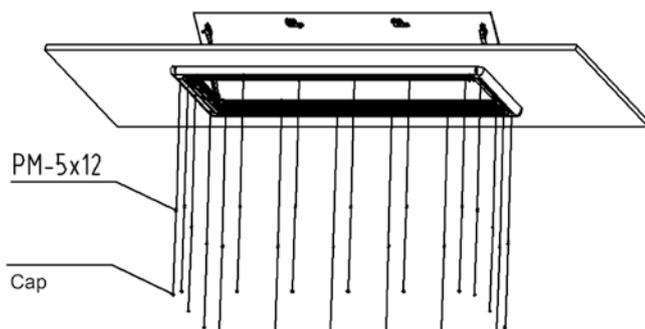
Schritt 5: Drehen Sie die Schrauben in die Blindbohrungen (nicht zu fest ziehen).
