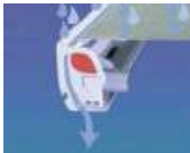
Regenrinne in der Frontblende leitet ablaufendes Regenwasser zu den Seiten ab.
