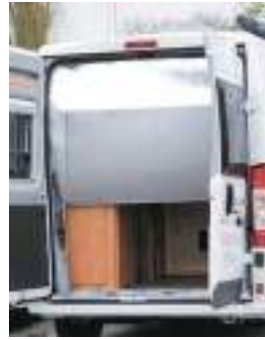
① Einteilige Hecktürisolierung
