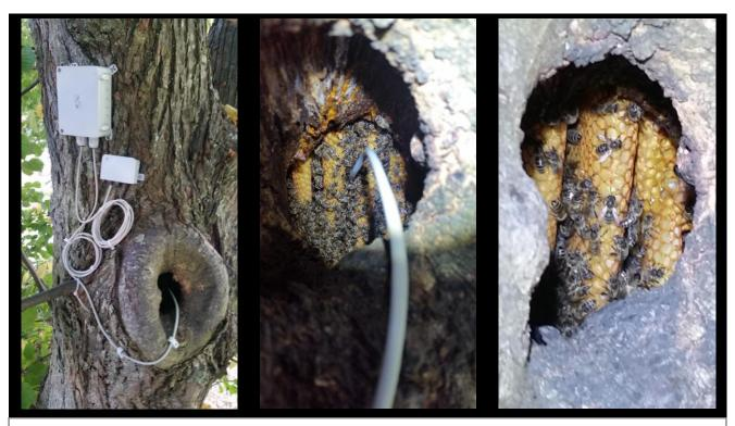
Bild links: Messgerät für die Temperatur- und Feuchtigkeitserfassung im Innern des Bienenvolks, sowie außen in der umgebenden Atmosphäre. Die Messungen zeigen, dass Schimmelwachstum, aufgrund der zu geringen Luftfeuchtigkeit in Baumhöhlen wie dieser, gar nicht erst entstehen kann.
