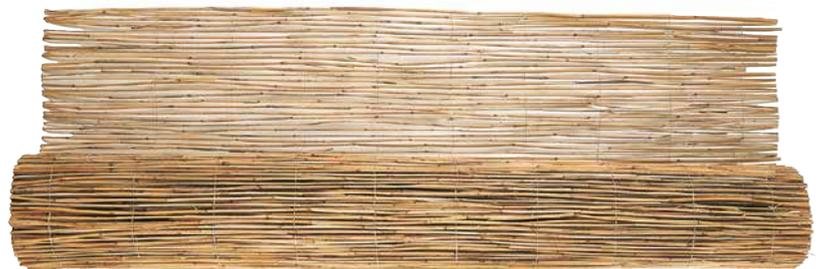
Putzträger auf Mischuntergründen und Holz. Das Gewebe aus Schilfrohr und Draht mit 70 Stängeln/lfm wurde in den 1980er Jahren von CLAYTEC wiederentdeckt und weiterentwickelt. Die Halmabstände passen perfekt zur Körnung grober Lehmputzmörtel. Es dient der Putzhaftung auf Holzbalken und gibt instabilen Wänden und dicken Auffüerungslagen Festigkeit.
