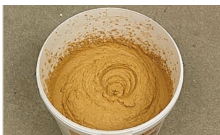
Nach 30 Min. kräftig durcharbeiten, das Bild zeigt die verarbeitungsfertige Konsistenz
