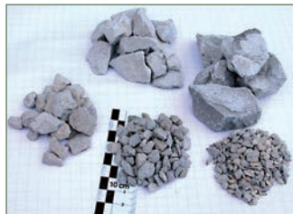
Splitt für Beton und Asphalt
