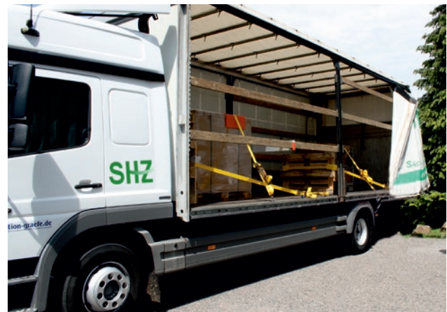
Kombination aus Kopf-Lashing und Niederzurrung
